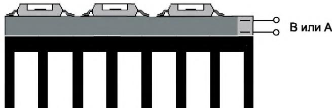
Рисунок 3 — Пример светодиодного модуля с несъемным радиатором
