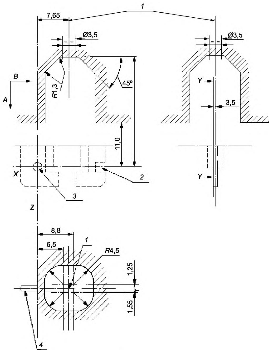
1 — ось круглой части диаметром 3,5 мм; 2 — паз; 3 — контрольное отверстие;
