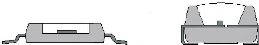
Рисунок 1 — Примеры корпусированных светодиодов
