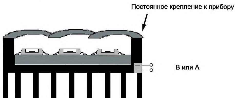
Рисунок 5 — Пример незаменяемого светодиодного источника света
