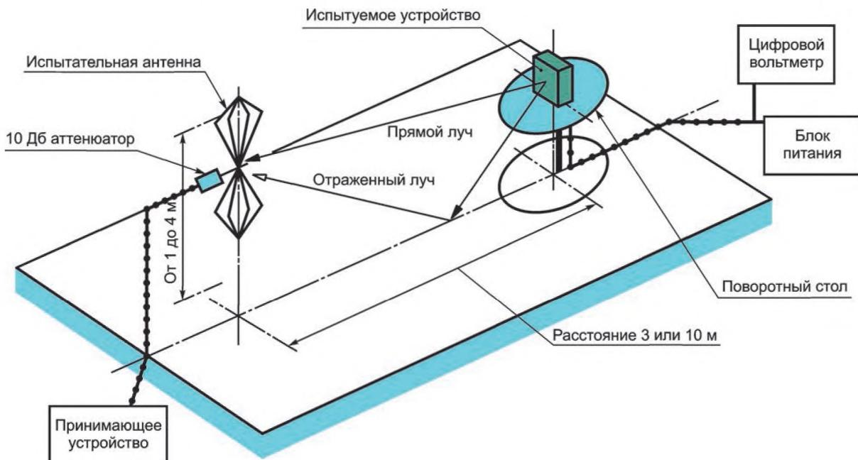
Рисунок А.4 — Измерительная установка на испытательной площадке с проводящим основанием
