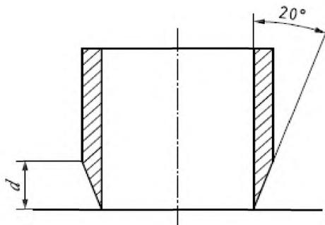
Рисунок 1 – Конструкция резака
