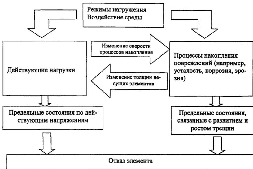
Рис. 1. Факторы, подлежащие учету при анализе надежности систем с пассивными элементами
