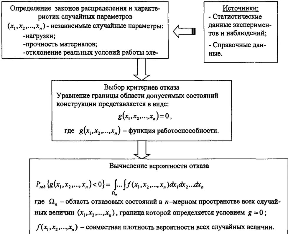
Рис. 1. Схема определения вероятности отказа пассивного элемента
