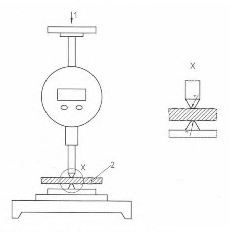
1 — сила (0,6  $\pm$  0,1) H, приложенная к верхнему нажимному наконечнику, 2 — испытуемый образец,  $^a$  — радиус вершины наконечника(1,0  $\pm$  0,1) мм
