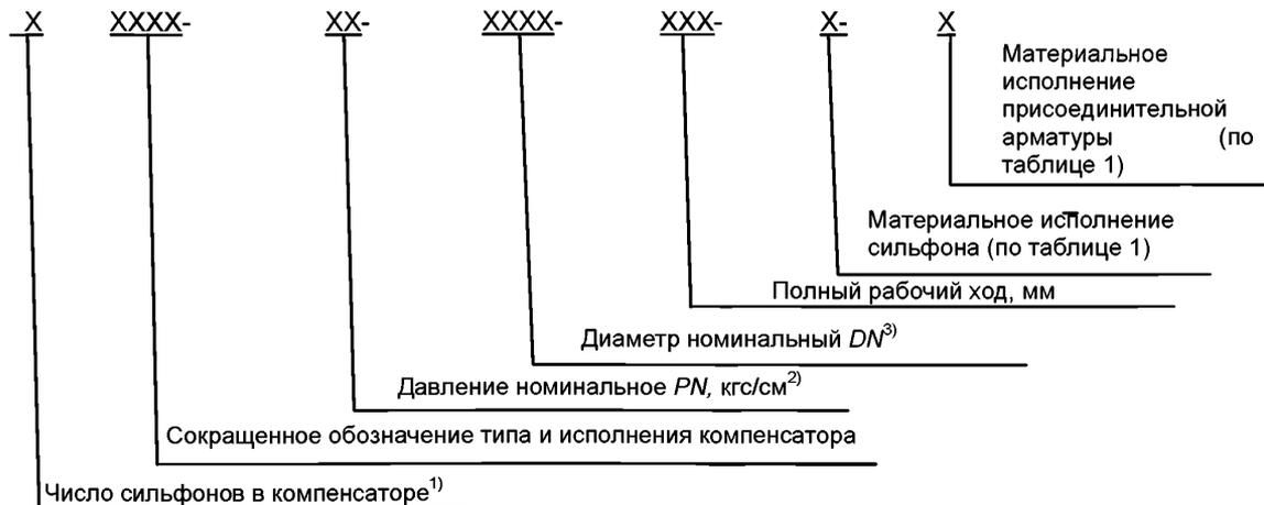
**А.2 Схема условных обозначений устройств**
