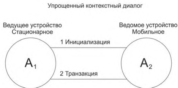
Рисунок 6 — Упрощенный контекстный диалог (типовая транзакция по дескриптору)
