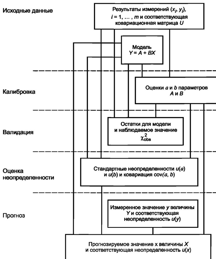
Рисунок 1 — Этапы определения и использования линейных калибровочных функций
