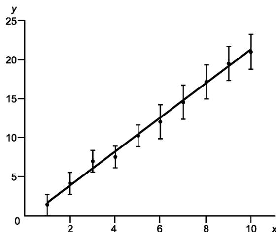
Рисунок 8 — Данные таблицы 22 и полученная линейная калибровочная функция
