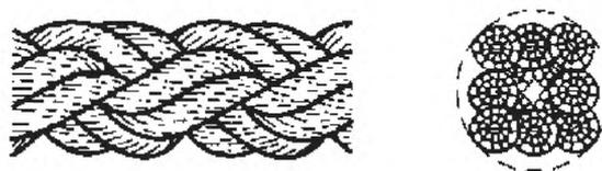
Рисунок 4 — Конфигурация 12-рядного плетеного каната (тип Т)
