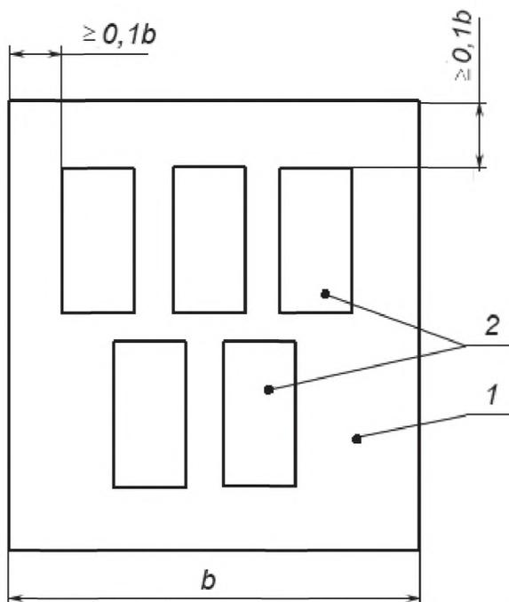
1 – пробка материала; 2 – образец материала;  $b$  – ширина пробы материала
