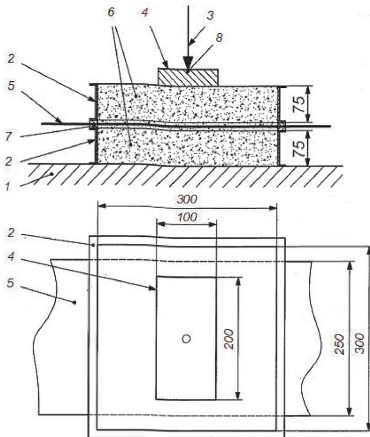
1 – массивное основание; 2 – испытательная форма; 3 – прикладываемая нагрузка; 4 – нагрузочная плита; 5 – испытуемый образец; 6 – дискретный наполнитель; 7 – прокладки; 8 – сферическое гнездо
