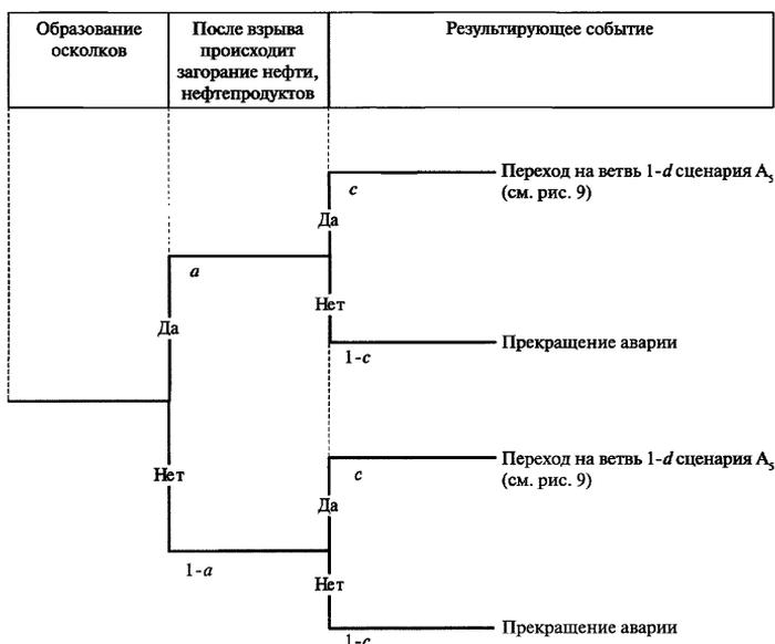
Рис. 10. Дерево событий при взрыве внутри подземного резервуара (типа ЖБР) (сценарий  $A_2$ )
