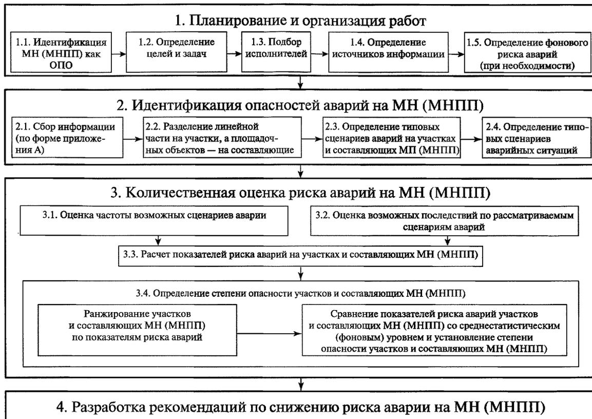
**Рис. 1.** Блок-схема проведения количественного анализа риска аварий на ОПО МН и МНПП
