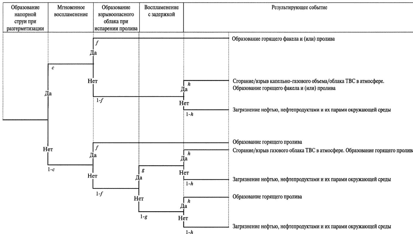
Рис. 3. Дерево событий при разгерметизации подземного участка ЛЧ ОПО МН и МНПП
