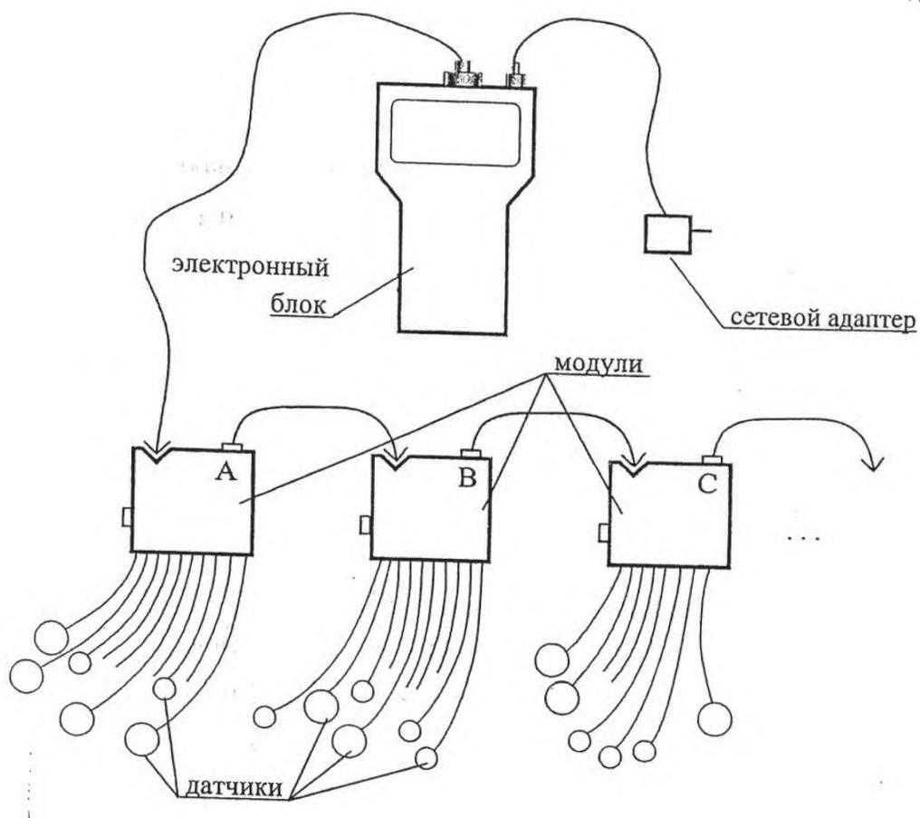
Рисунок А.1 – Схема кабельных соединений преобразователей теплового потока и датчиков температуры измерителя ИТП-МГ 4.03 «Поток»
