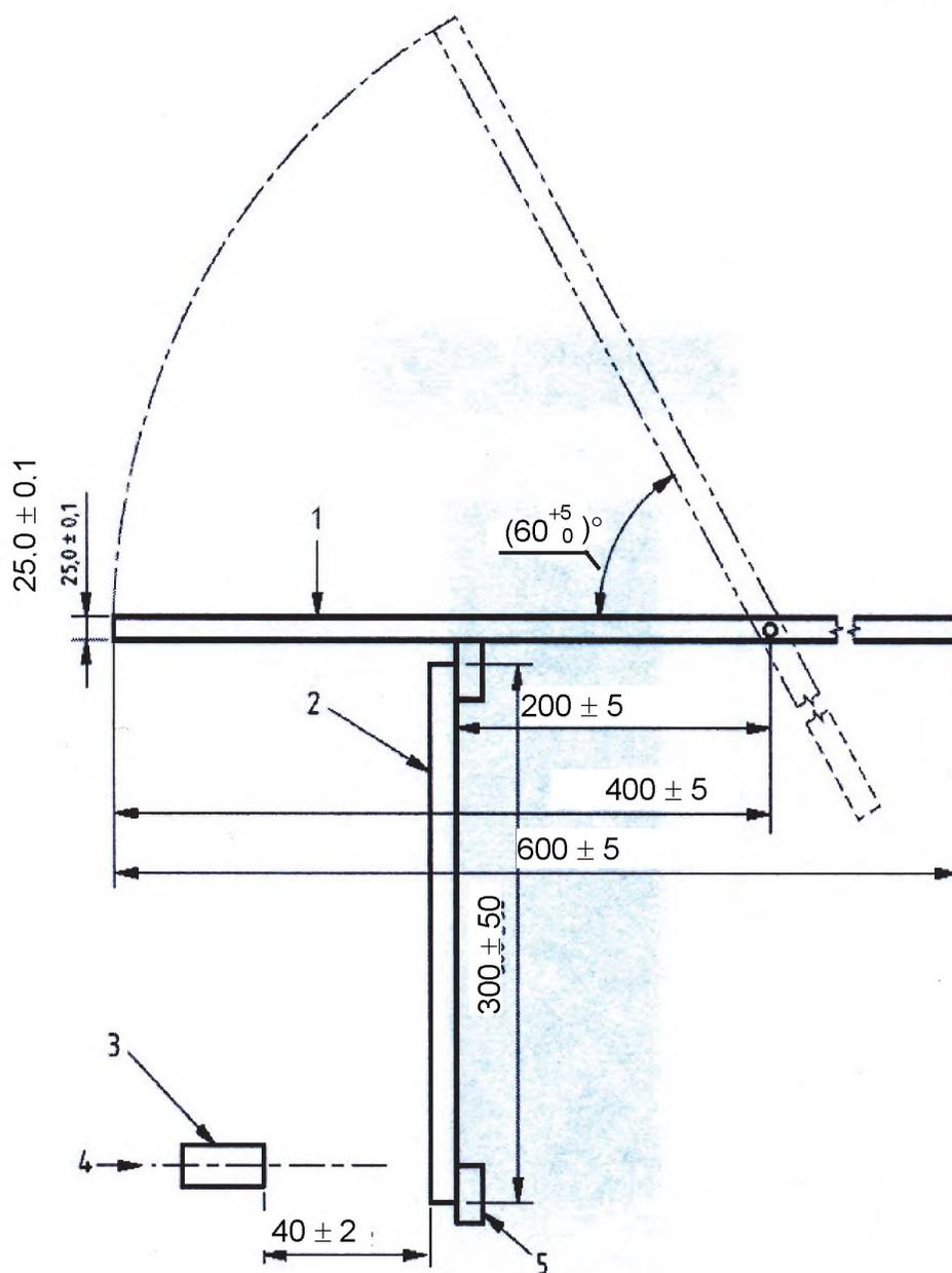
1 – ударное устройство; 2 – панель; 3 – газовая горелка; 4 – осевая линия фронтальной поверхности горелки;
