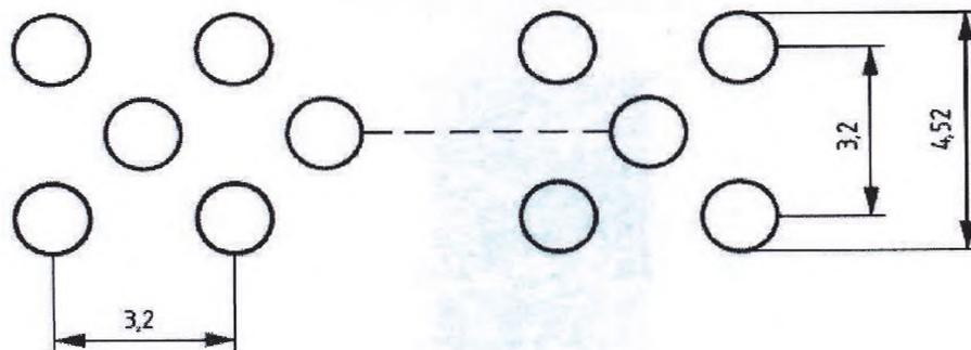
Рисунок 5 – Фронтальная поверхность рабочей части горелки
