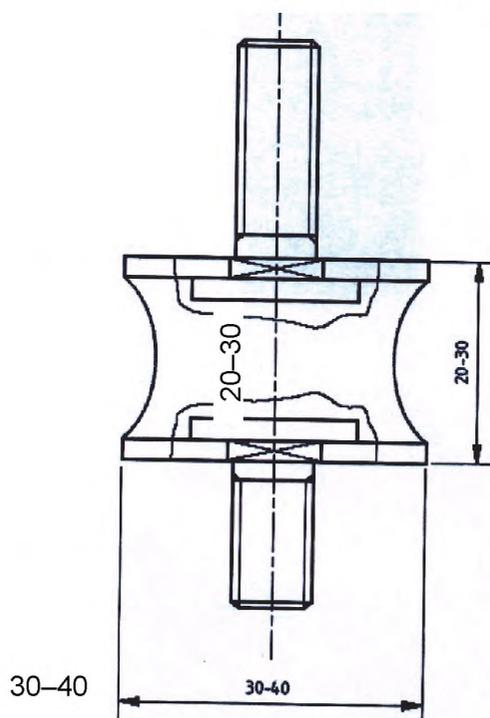
Рисунок 4 – Типичная резиновая втулка для крепления испытательной панели
