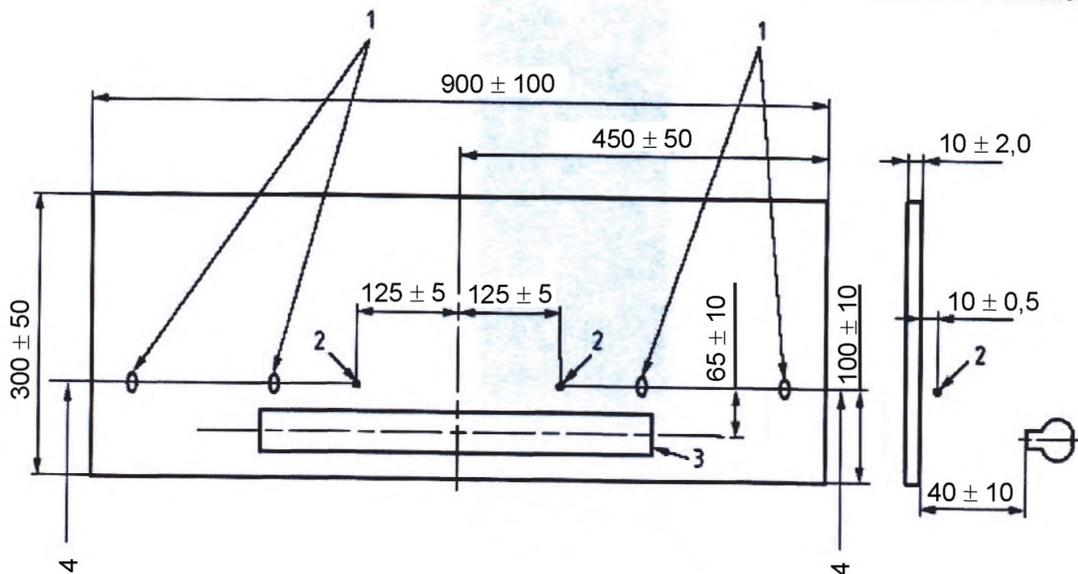
1 – опоры для термопар; 2 – кончик термопары; 3 – горелка;
