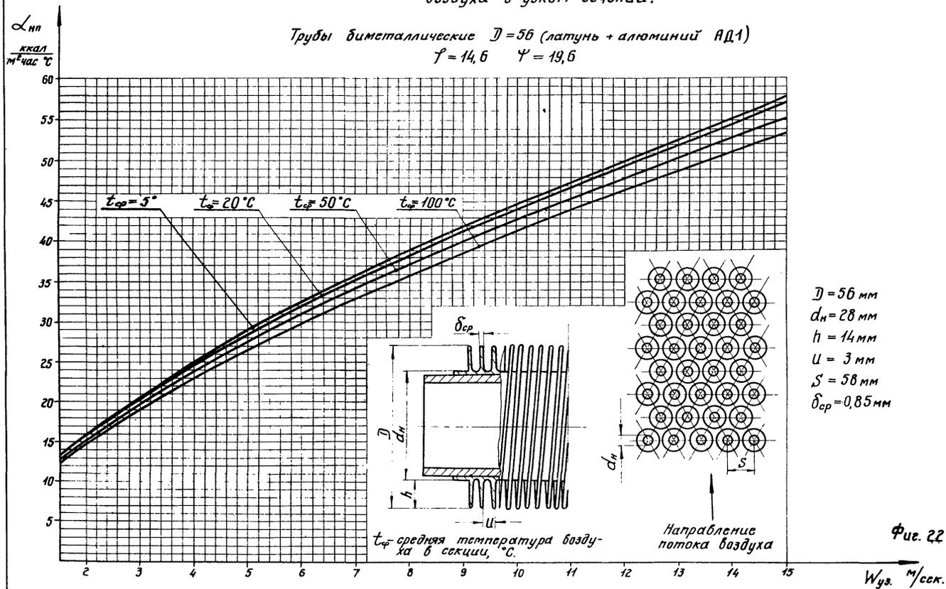
Зависимость коэффициента теплоотдачи к воздуху от скорости воздуха в узком сечении.
