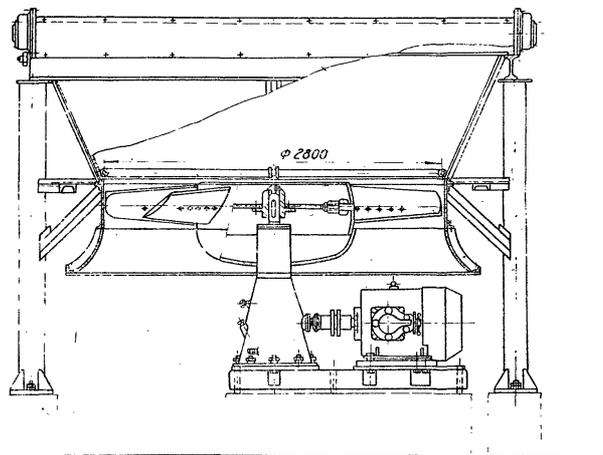
Аппарат воздушного охлаждения горизонтального типа
