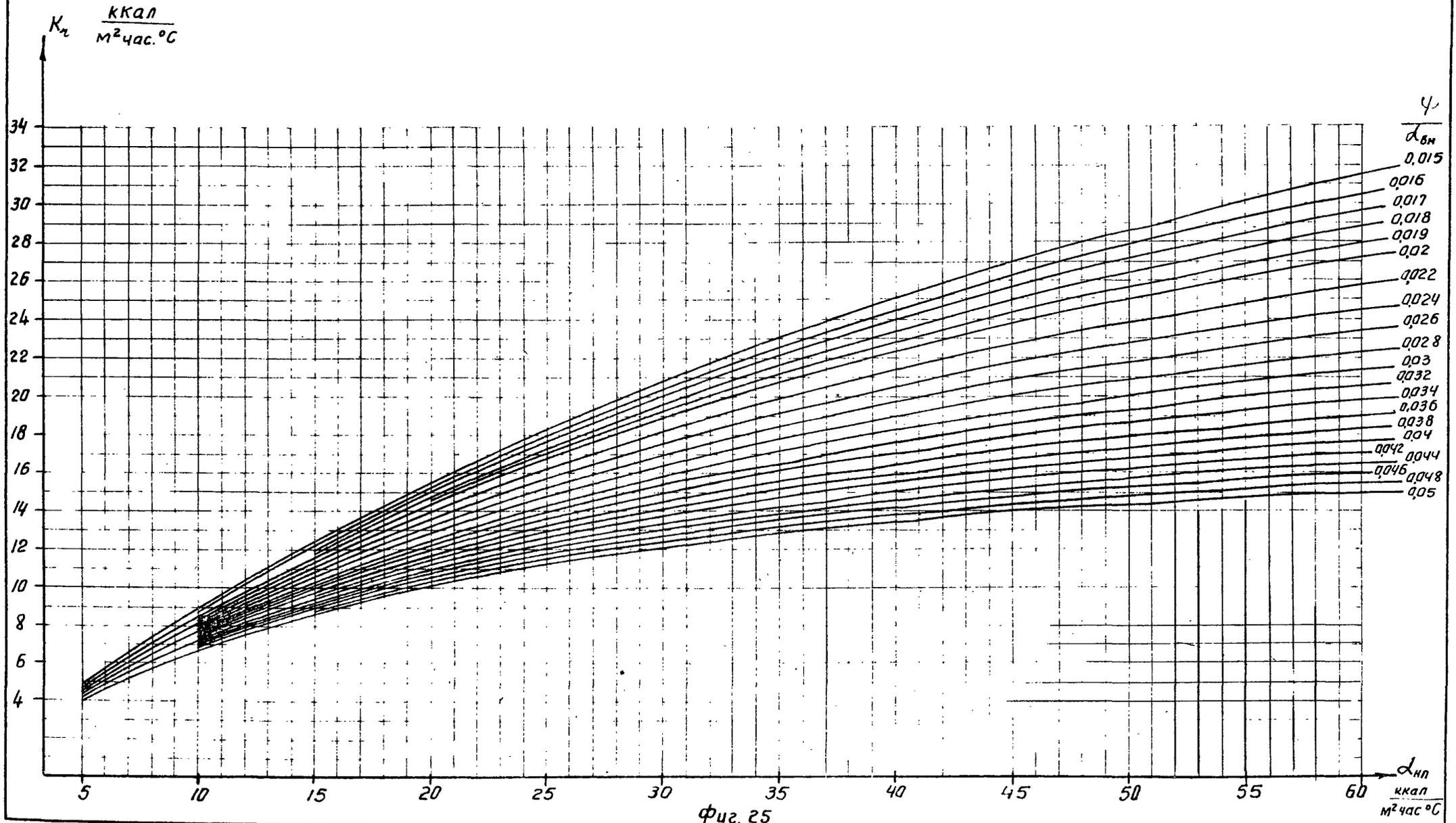
Зависимость коэффициента теплопередачи (без учета загрязнения) от коэффициента теплоотдачи со стороны воздуха при различных значениях  $\frac{\psi}{\alpha_{вн}}$
