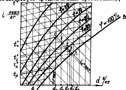
процесс изменения состояния воздуха идет из т.0. (соответствующей воздуху с температурой по сухому термометру  $t_0$ , относительной влажностью  $\varphi = 70\%$  и влагосодержанием  $d_0$ ) при постоянном теплосодержании  $i_0 = \text{const}$ , но с понижением температуры и увеличением относительной влажности.
