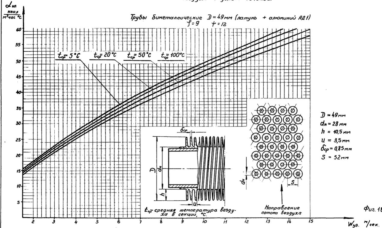
Зависимость коэффициента теплоотдачи к воздуху от скорости воздуха в узком сечении.
