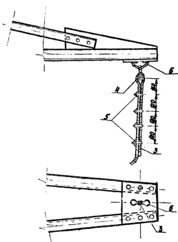
Рис. 10. Крепление тягового троса к траверсе опоры
