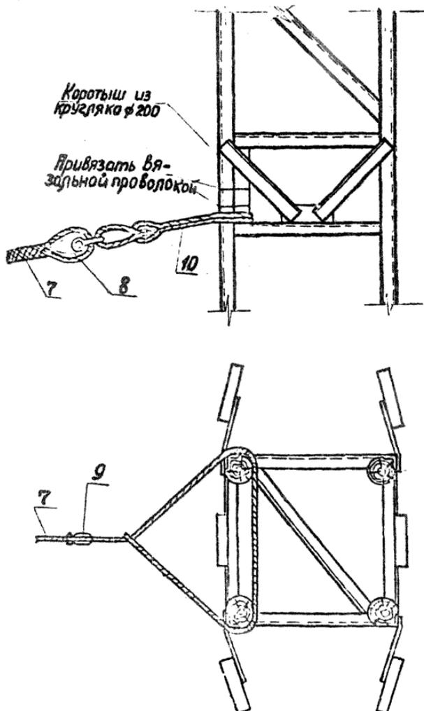
Рис. II. Крепление тормозного троса к стойке опоры
