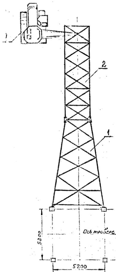
Рис. 55 Сборка нижней плоскости 1<sup>ой</sup> 2<sup>ой</sup> секции стовба
