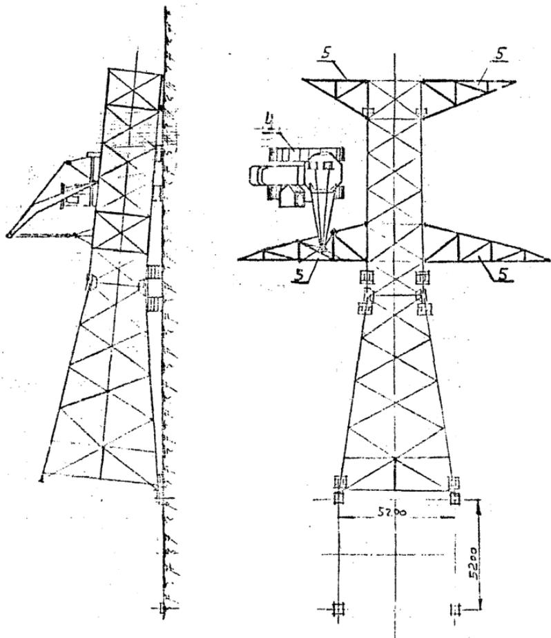
Рис. 58 Пристыковка траверс к стволу опоры У220-З.
