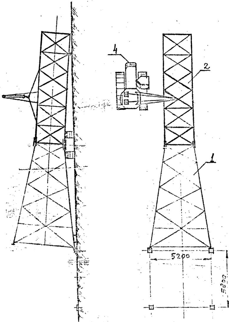
Рис. 38 Пристыковка 2<sup>ой</sup> секции ствола опоры 4220-1
