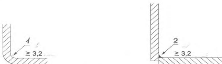
1 – радиус, образованный механической обработкой фасонным резцом
