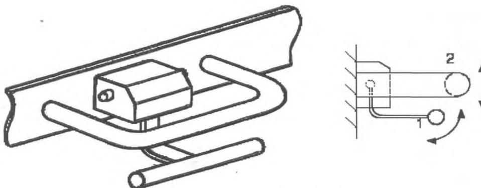
1 – рычаг снятия блокировки; 2 – рабочий рычаг
