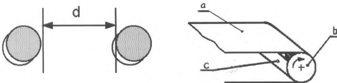
$a$  – загрузочное устройство закладки и выемки;  $b$  – вал;  $c$  – защитное ограждение зоны захвата;  $d \geq 260$
