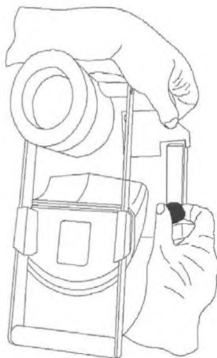
Рисунок 9 – Использование обеих рук для открывания кожуха
