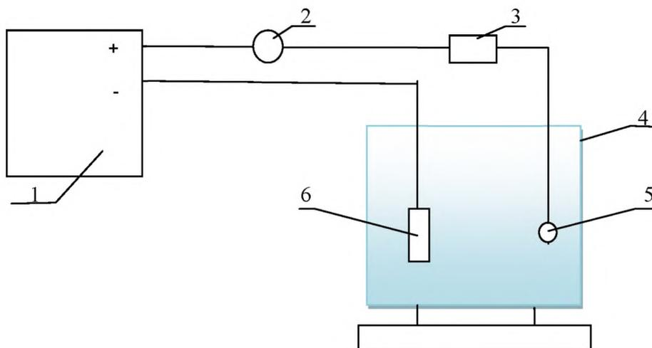
1 — блок питания, 2 — миллиамперметр, 3 — резистор, 4 — стакан лабораторный с 1М раствором соляной кислоты  $\text{HCl}$ , 5 — серебряный электрод, 6 — вспомогательный платиновый электрод
