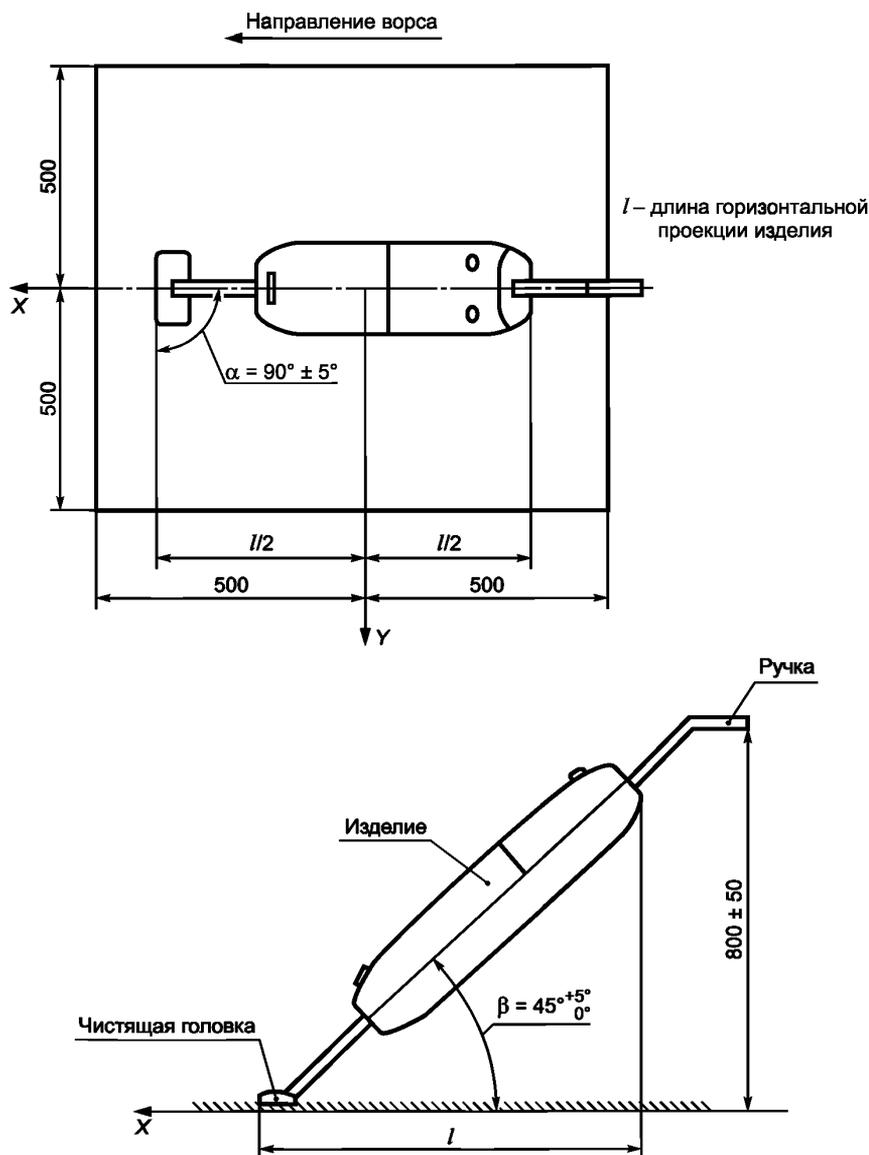
Рисунок 101 — Изделие с чистящей головкой прямого соединения
