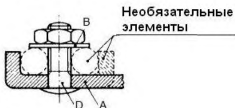
б) пример винтового зажима с передачей давления головкой винта через промежуточную деталь
