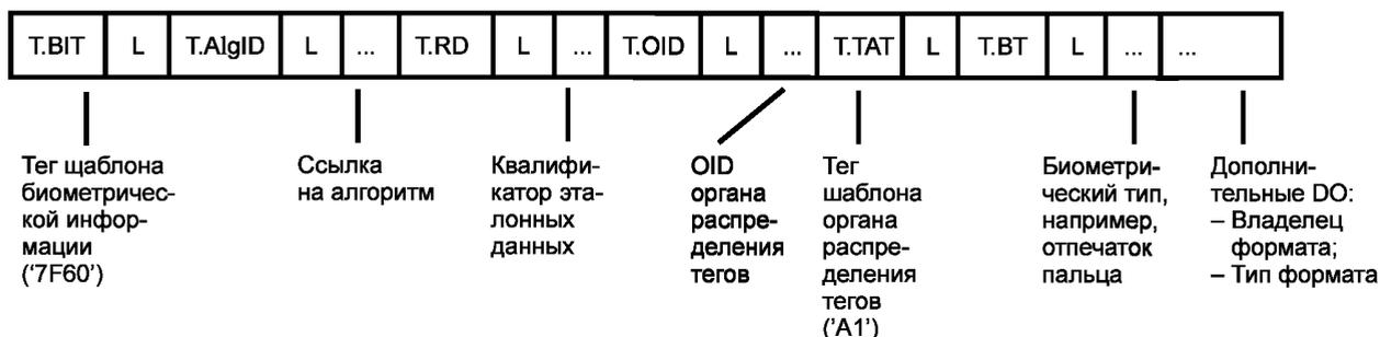
Рисунок В.5 — Пример шаблона биометрической информации (BIT)
