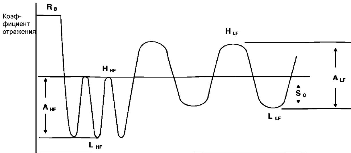
**П р и м е ч а н и е 1** – Отношение низкочастотного сигнала к фоновому уровню сигнала — отношение значения высокого коэффициента отражения комбинации низкочастотных данных ( $H_{LF}$ ) к фоновому коэффициенту отражения ( $R_B$ ).
