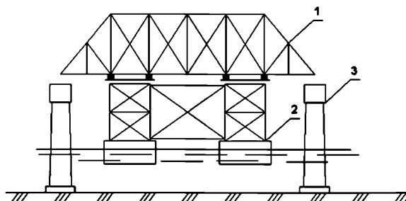
1 – собранная ферма; 2 – плавучая опора; 3 – капитальная опора
