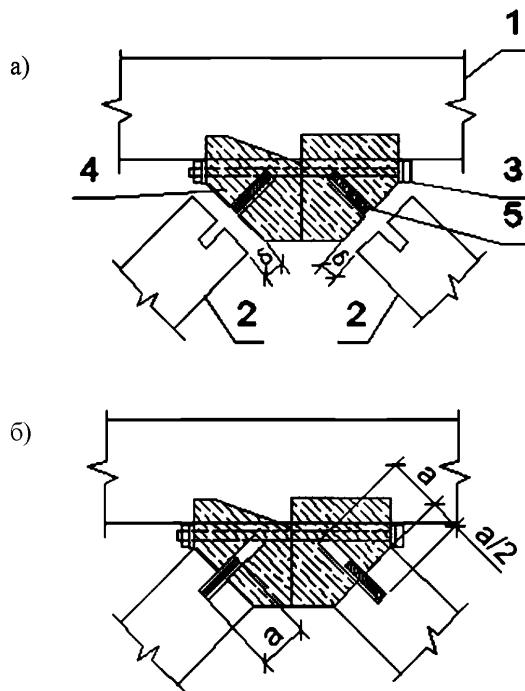
а) положение конструкций непосредственно перед монтажом; верхний пояс опирается на верхний ярус подмостей; б) смонтированный узел
