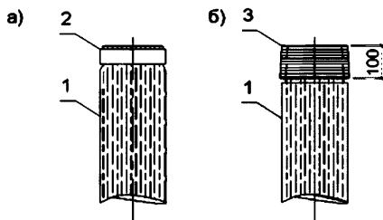
а) усиление головы сваи бугелем; б) то же, обмоткой из проволоки
