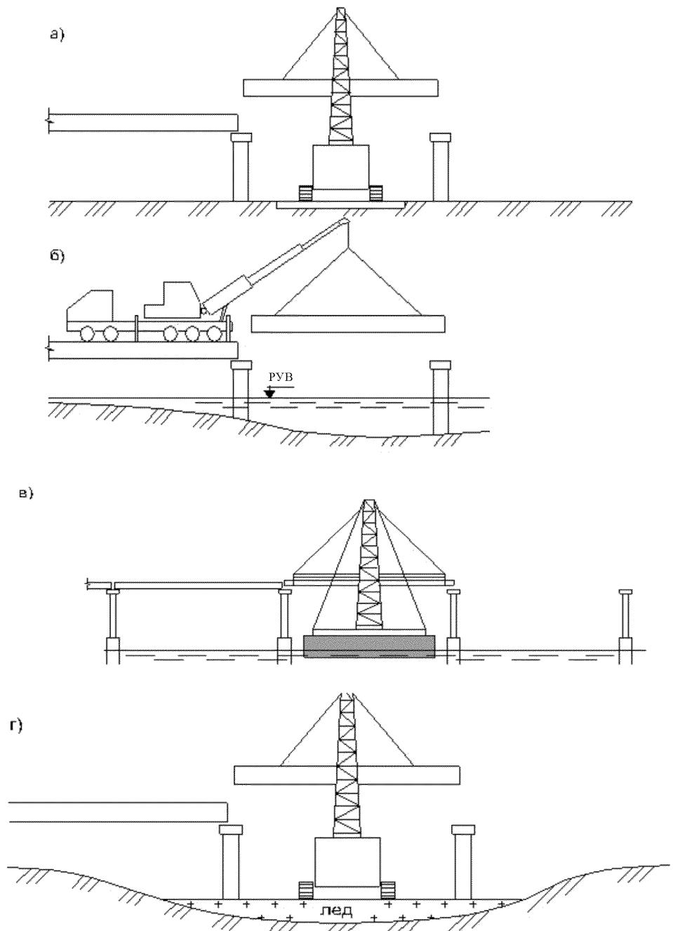
а) с грунта; б) с готовой части моста «впереди себя»; в) с плавучих средств; г) со льда
