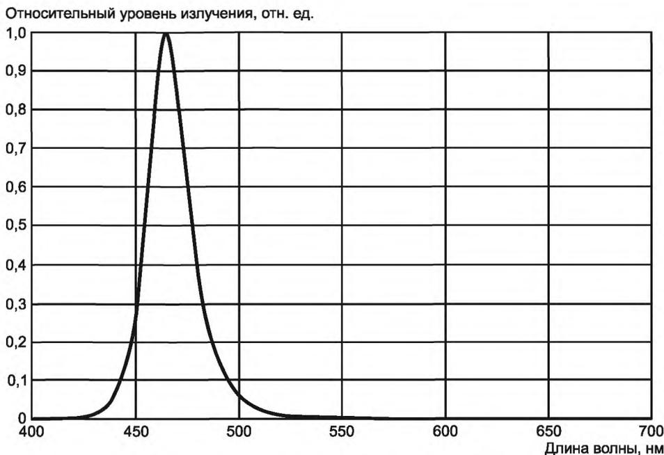
Рисунок ДБ.4 — Спектр излучения светоизлучающего диода с рабочими длинами волн в голубой области видимого спектра
