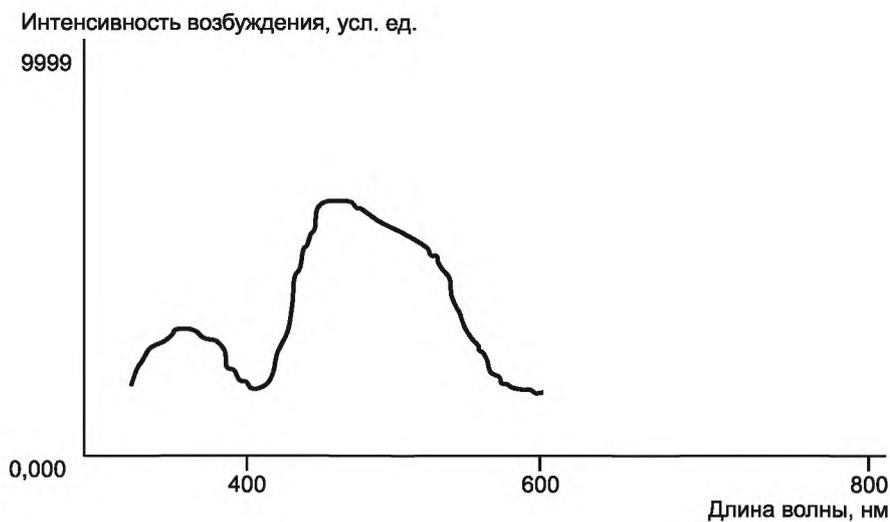
Рисунок ДБ.2 — Пример спектра возбуждения люминесцентного вещества
