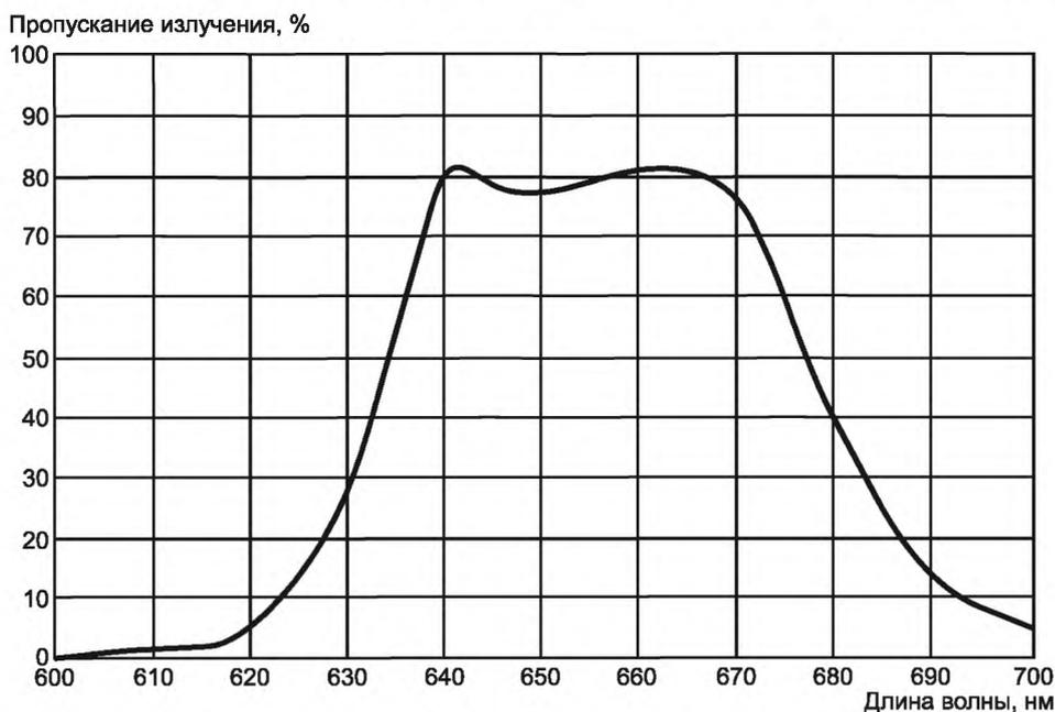
Рисунок ДБ.5 — Спектральная характеристика коэффициента пропускания светофильтра 5
