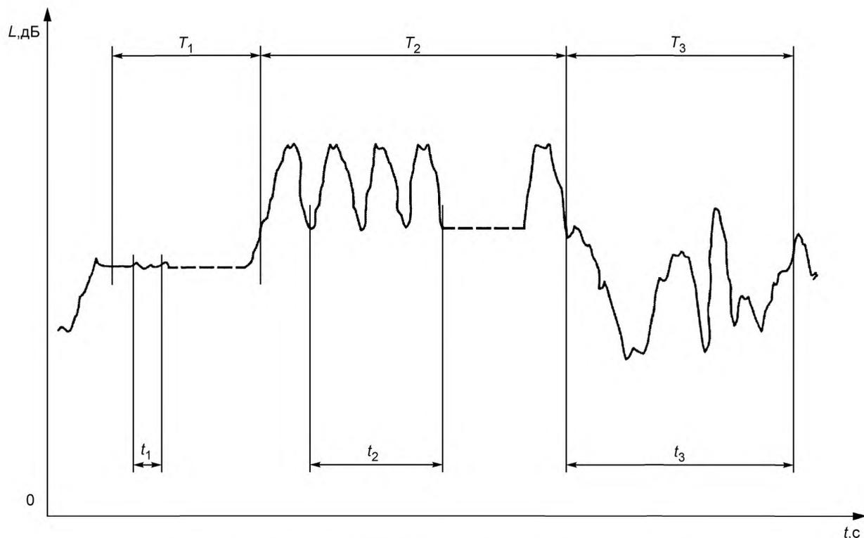
$L$  — уровень шума как функция времени;  $T_1$  — продолжительность рабочей операции 1;  $T_2$  — продолжительность рабочей операции 2;  $T_3$  — продолжительность рабочей операции 3;  $t$  — время;  $t_1$  — длительность измерения шума операции 1 (почти постоянный шум);  $t_2$  — длительность измерения шума операции 2 (почти периодический шум);  $t_3$  — длительность измерения шума операции 3 (непостоянный шум)
