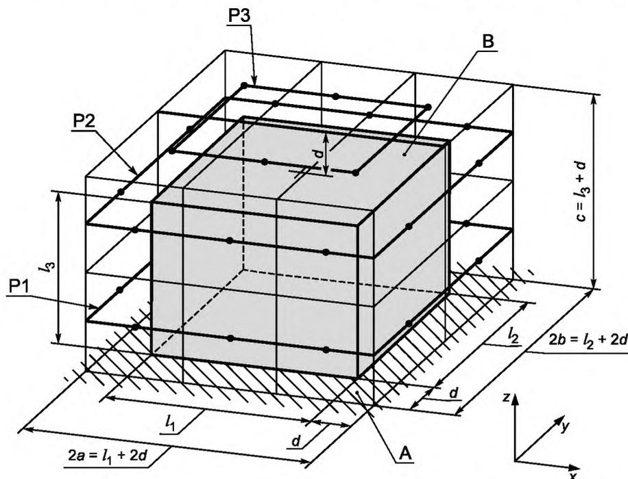
● — точки установки микрофонов; А — звукоотражающая плоскость; В — огибающий параллелепипед;  $2a$  — длина параллелепипеда измерительной поверхности;  $2b$  — ширина параллелепипеда измерительной поверхности;  $c$  — высота параллелепипеда измерительной поверхности;  $d$  — измерительное расстояние;  $l_1$  — длина огибающего параллелепипеда;  $l_2$  — ширина огибающего параллелепипеда;  $l_3$  — высота огибающего параллелепипеда; P1, P2, P3 — траектории сканирования
