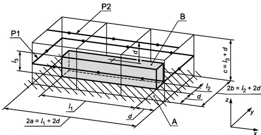
● — точки установки микрофонов; А — звукоотражающая плоскость; В — огибающий параллелепипед;  $2a$  — длина параллелепипеда измерительной поверхности;  $2b$  — ширина параллелепипеда измерительной поверхности;  $c$  — высота параллелепипеда измерительной поверхности;  $d$  — измерительное расстояние;  $l_1$  — длина огибающего параллелепипеда;  $l_2$  — ширина огибающего параллелепипеда;  $l_3$  — высота огибающего параллелепипеда; P1, P2 — траектории сканирования
