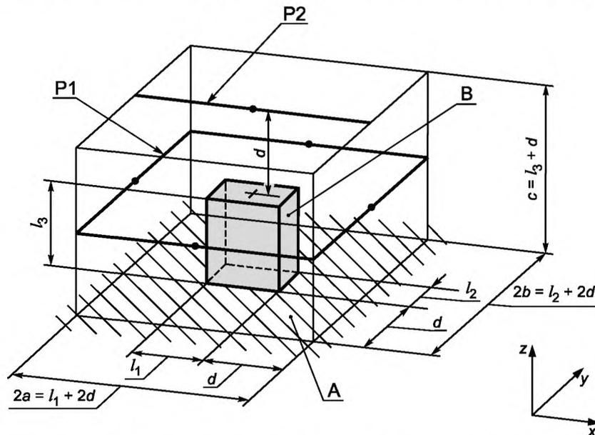
• — точки установки микрофонов; А — звукоотражающая плоскость; В — огибающий параллелепипед;  $2a$  — длина параллелепипеда измерительной поверхности;  $2b$  — ширина параллелепипеда измерительной поверхности;  $c$  — высота параллелепипеда измерительной поверхности;  $d$  — измерительное расстояние;  $l_1$  — длина огибающего параллелепипеда;  $l_2$  — ширина огибающего параллелепипеда;  $l_3$  — высота огибающего параллелепипеда; P1, P2 — траектории сканирования
