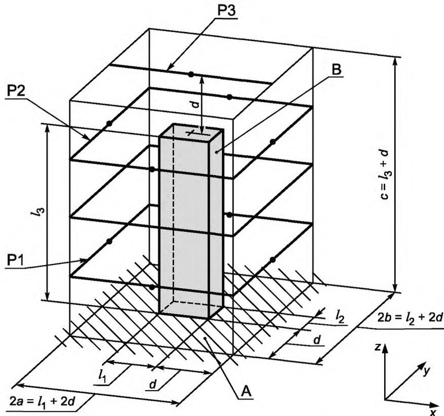
● — точки установки микрофонов; А — звукоотражающая плоскость; В — огибающий параллелепипед;  $2a$  — длина параллелепипеда измерительной поверхности;  $2b$  — ширина параллелепипеда измерительной поверхности;  $c$  — высота параллелепипеда измерительной поверхности;  $d$  — измерительное расстояние;  $l_1$  — длина огибающего параллелепипеда;  $l_2$  — ширина огибающего параллелепипеда;  $l_3$  — высота огибающего параллелепипеда; P1, P2, P3 — траектории сканирования
