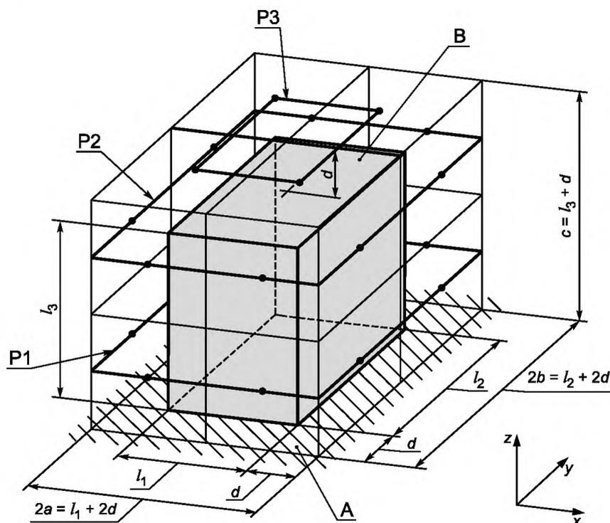
● — точки установки микрофонов; А — звукоотражающая плоскость; В — огибающий параллелепипед;  $2a$  — длина параллелепипеда измерительной поверхности;  $2b$  — ширина параллелепипеда измерительной поверхности;  $c$  — высота параллелепипеда измерительной поверхности;  $d$  — измерительное расстояние;  $l_1$  — длина огибающего параллелепипеда;  $l_2$  — ширина огибающего параллелепипеда;  $l_3$  — высота огибающего параллелепипеда; P1, P2, P3 — траектории сканирования
