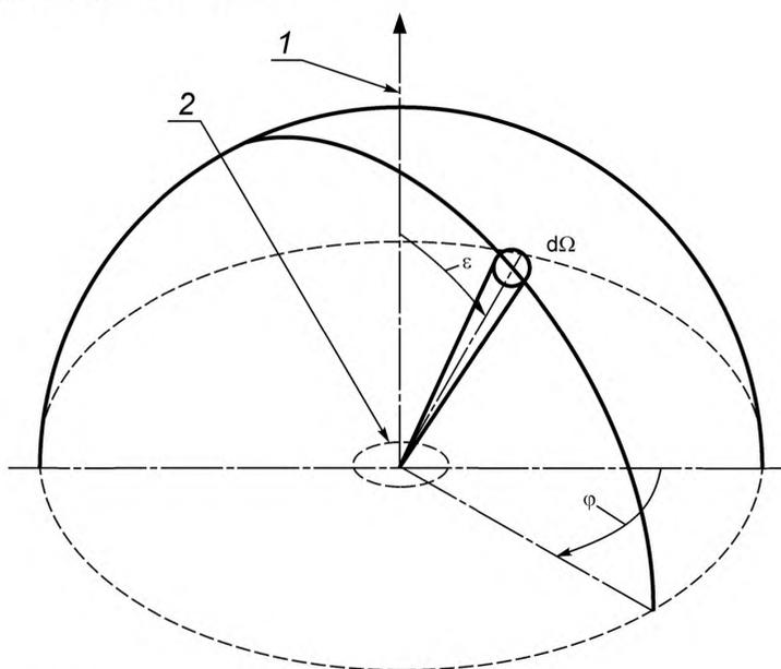
1 — оптическая ось; 2 — входная диафрагма;  $\varepsilon$  — угол падения, измеренный относительно оптической оси;
