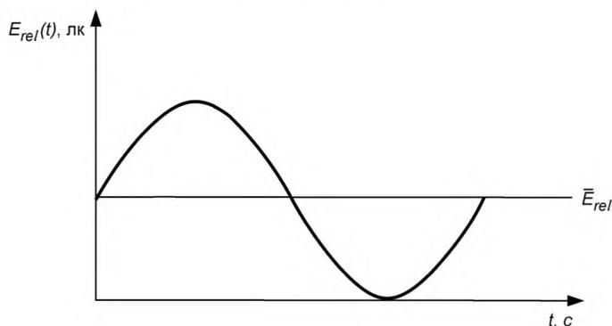
Рисунок 14 — Синусоидально модулированный свет первого уровня модуляции
