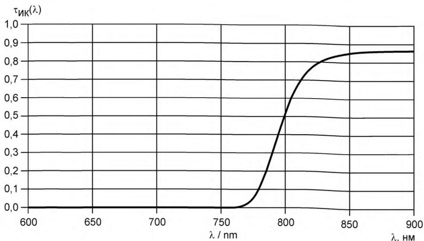
Рисунок 4 — Спектральный коэффициент пропускания  $\tau_{ИК}(\lambda)$  ИК-фильтра
