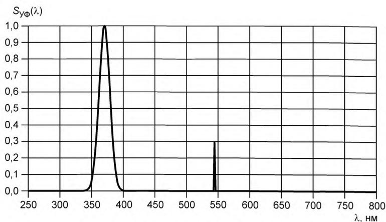
Рисунок 2 — Относительное спектральное распределение излучения  $S_{уф}$
