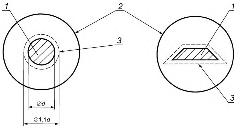
1 — измеряемое поле (диаметр  $d$ ); 2 — наблюдаемое поле; 3 — ловушка
