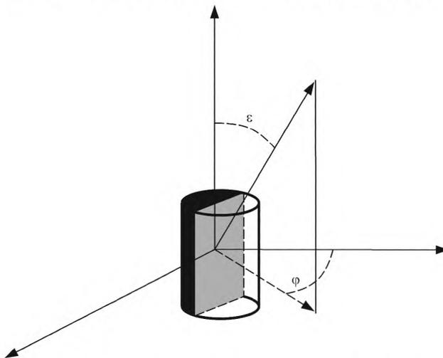
Рисунок 8 — Система координат для определения функции  $f_{2,SC}(\varepsilon, \varphi)$
