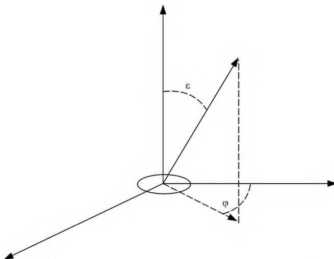
Рисунок 5 — Система координат для определения функции  $f_2(\varepsilon, \varphi)$
