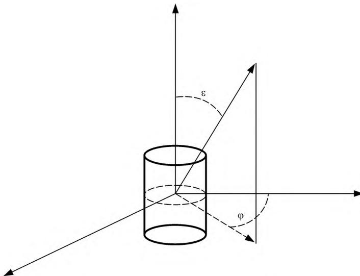
Рисунок 7 — Система координат для определения функции  $f_{2,c}(\varepsilon, \varphi)$
