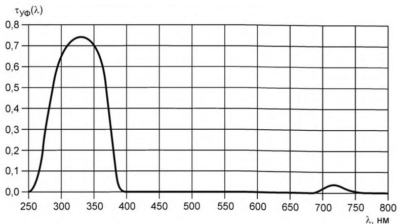
Рисунок 3 — Спектральный коэффициент пропускания  $\tau_{уф}(\lambda)$  УФ-фильтра
