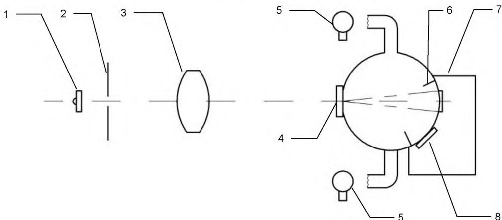
1 – фотодетектор, 2 – апертурная диафрагма, 3 – линза, 4 – образец,
