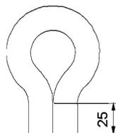
Рисунок 103 – Конфигурация шланга для его замораживания
