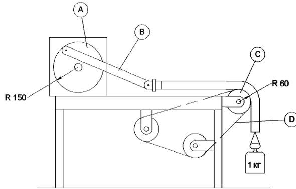
A – кривошипный механизм; B – соединительная тяга; C – ролик диаметром 120 мм;
