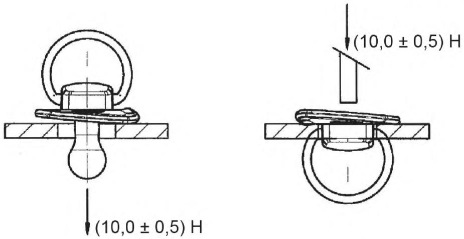
Рисунок 11 – Испытание защитного диска (5.2.3.2)
