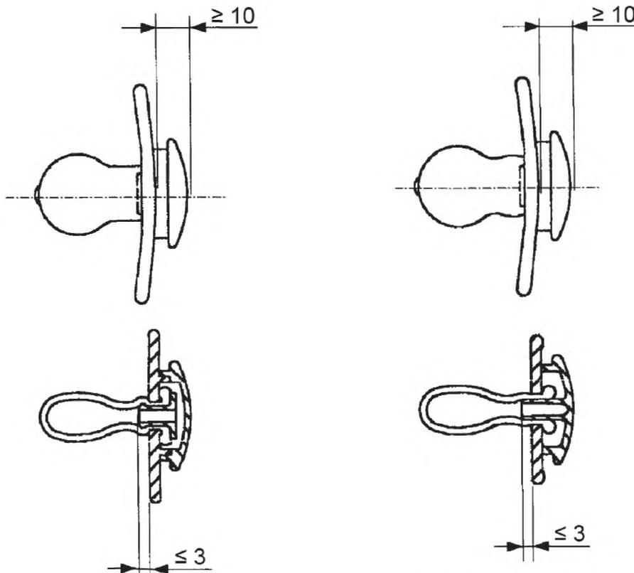
Рисунок 15 – Измерение расположения головки, пробки, крышки
