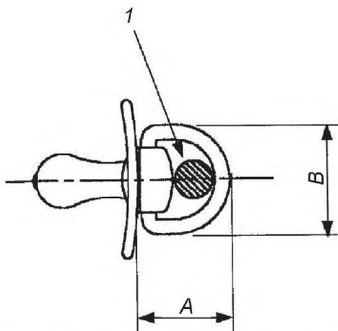
A – размер A; B – размер B; 1 – поперечное сечение стержня диаметром 14 мм
