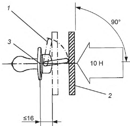
1 – положение кольца с приложенным к нему усилием, равным 10 Н; 2 – ровная плита; 3 – задняя часть защитного диска вдоль основной оси
