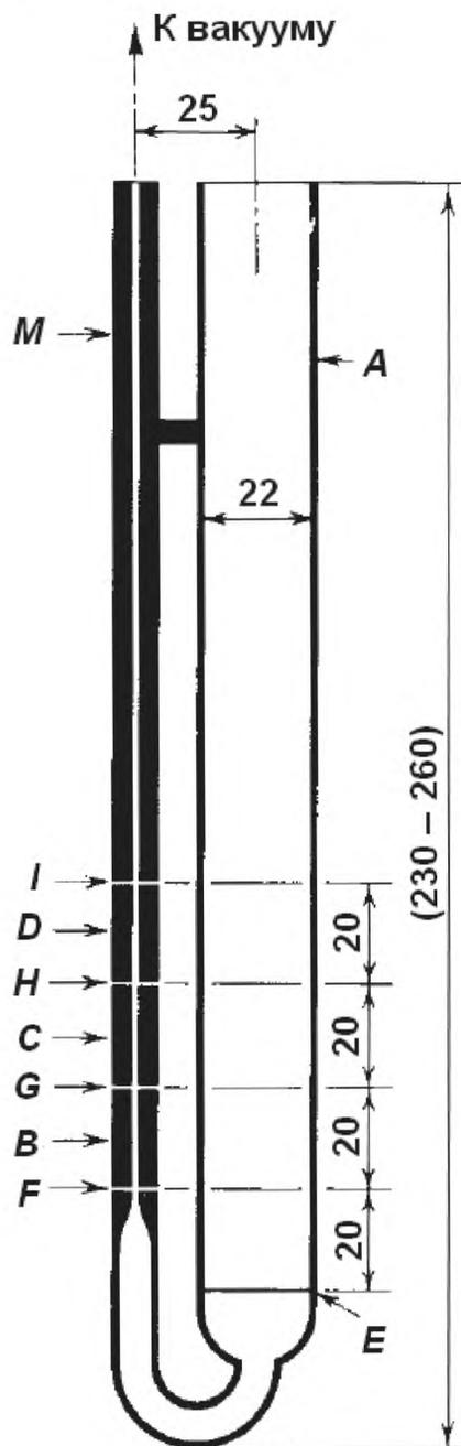
A – трубка заполнения; B, C, D – шарики; E – линия заполнения; F – первая метка времени; G – вторая метка времени; H – третья метка времени; I – четвертая метка времени; M – вакуумная трубка
