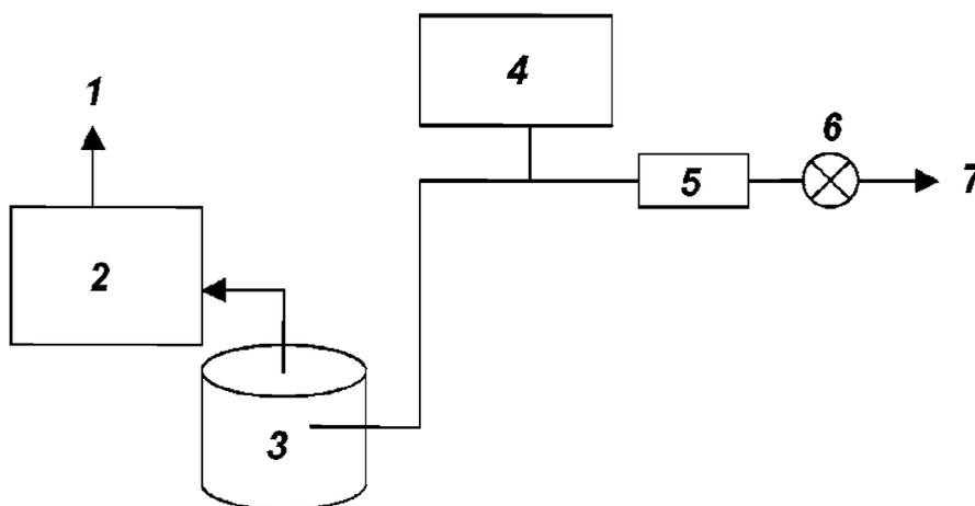
1 – к вакуумному насосу; 2 – система контроля давления; 3 – буферный резервуар вместимостью 1 дм<sup>3</sup>; 4 – манометр; 5 – ловушка; 6 – переключающий кран; 7 – к вискозиметру
