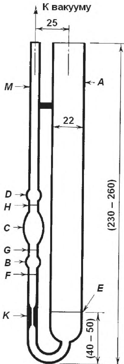
*A* – трубка заполнения; *B, C, D* – шарики; *E* – линия заполнения; *F* – первая метка времени; *G* – вторая метка времени; *H* – третья метка времени; *K* – капилляр; *M* – вакуумная трубка
