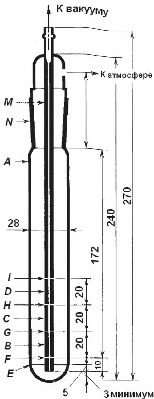
*A* – трубка заполнения; *B*, *C*, *D* – шарики; *E* – линия заполнения; *F* – первая метка времени; *G* – вторая метка времени; *H* – третья метка времени; *I* – четвертая метка времени; *M* – вакуумная трубка; *N* – притертое стеклянное конусное соединение 24/40
