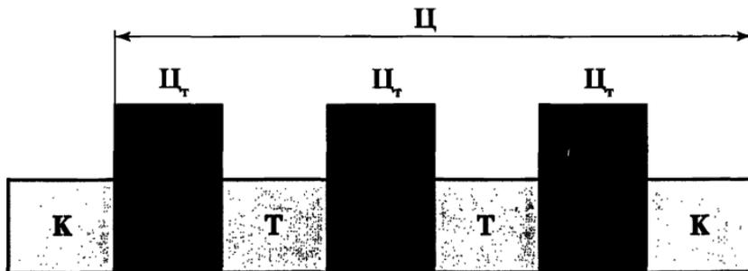
Рис. 1. Структурная схема ремонтного цикла
