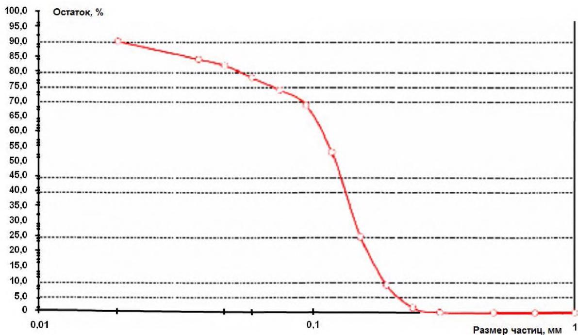
Рисунок В.1 – Типичный гранулометрический состав испытательного силикатного наполнителя 315-001
