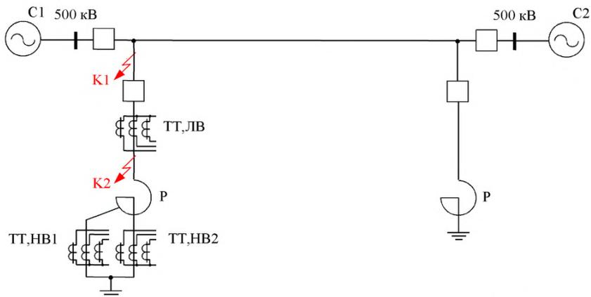
Рисунок 2.2 – Схема защищаемого ШР и прилегающей сети
