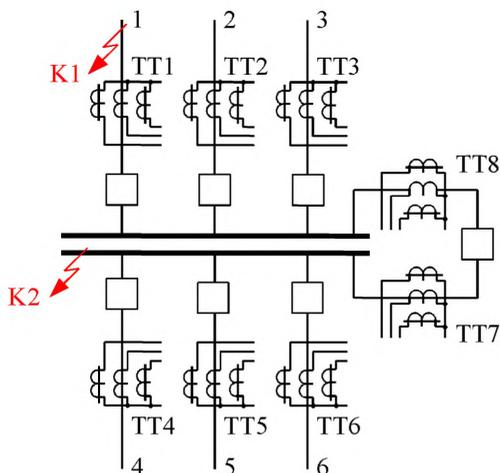
Рисунок 3.2 – Схема для расчета защиты шин
