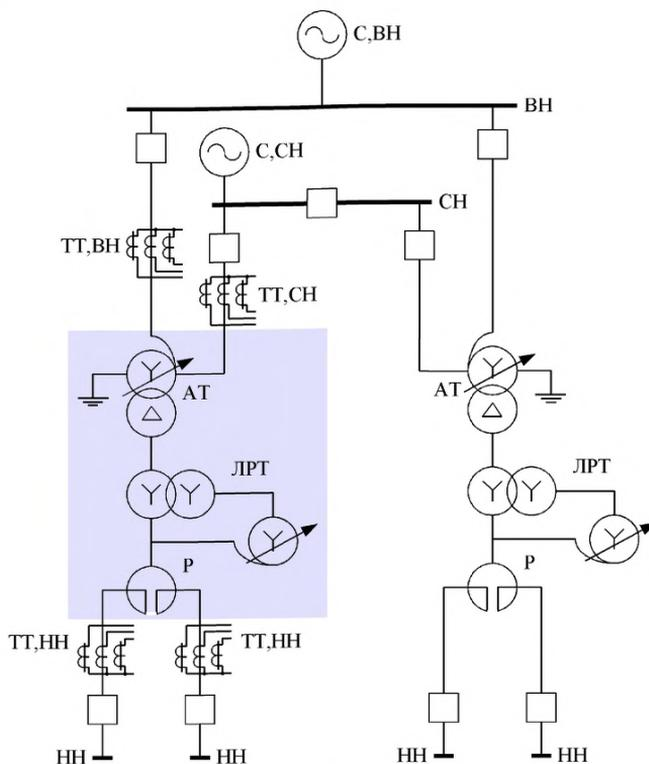
Рисунок 1.4 – Исходная схема защищаемого автотрансформатора и прилегающей сети
