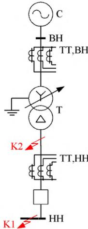
Рисунок 1.2 – Исходная схема защищаемого трансформатора и прилегающей сети
