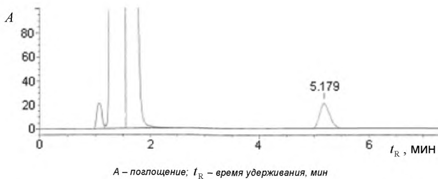
Рисунок В.2 – Хроматограмма, полученная на УФ детекторе при длине волны \lambda = 254 нм для МАМА-производного HDI
