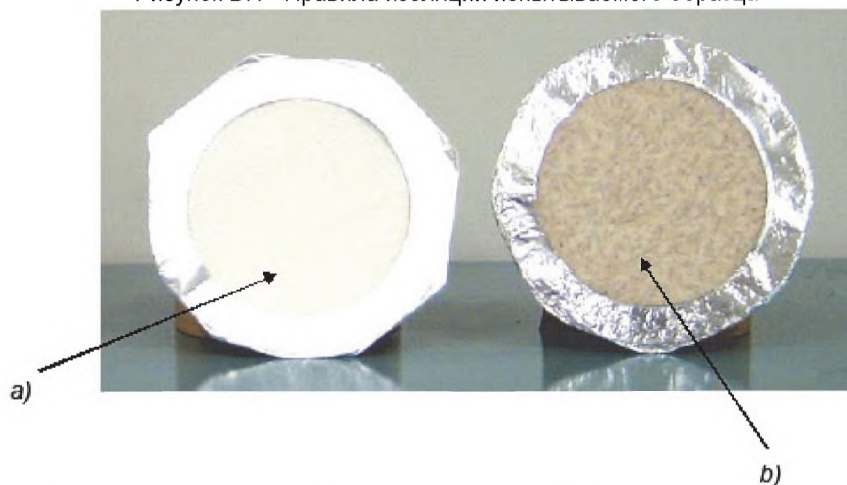
Рисунок D.2– Реальные примеры изолированных испытываемых образцов
