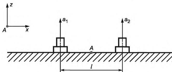
Рисунок 6 — Измерение скорости поступательного и углового движения
