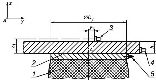
1 — изолятор; 2 — установочный фланец изолятора; 3 — положение 1-го акселерометра ( $x_1, y_1, z_1$ ); 4 — положение 2-го акселерометра ( $x_2, y_2, z_2$ ); 5 — положение 3-го акселерометра ( $x_3, y_3, z_3$ )
