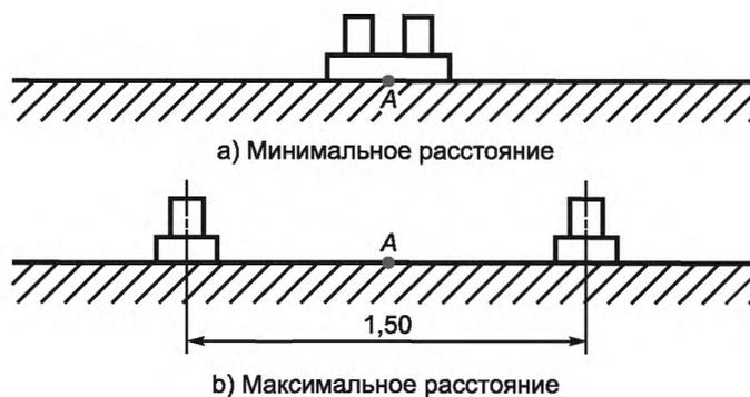
Рисунок В.1 — Установка акселерометров при определении  $f_2$
