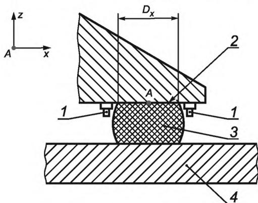
1 — акселерометр; 2 — опора; 3 — изолятор; 4 — фундамент
