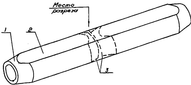
**Рис.2. Разрезание корпуса стандартного соединительного зажима пополам:**
