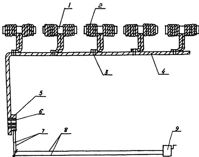
Рис.25. Электрическая схема опрессовки соединительных (шлейфовых) зажимов:
