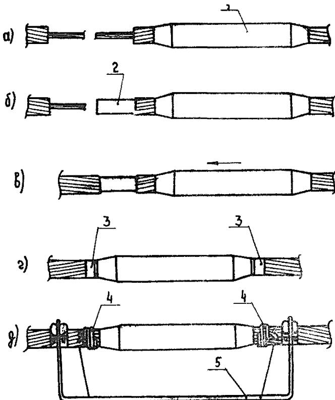
Рис.18. Монтаж соединительного зажима на проводах:
