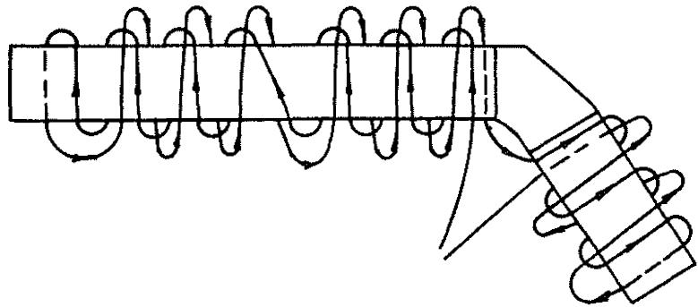
Рис.7. Схема намотки ДШ на корпус патчного зажима.
