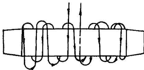
Рис.9. Схема намотки ДШ на корпус шлейфового зажима.
