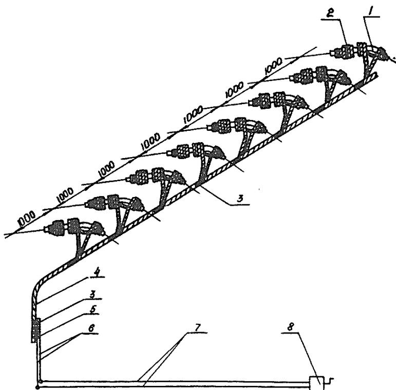
Рис.16. Электрическая схема опрессовки натяжных зажимов методом взрыва:
