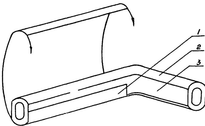
Рис.3. Немотка защитного слоя на корпус натяжного зажима:
