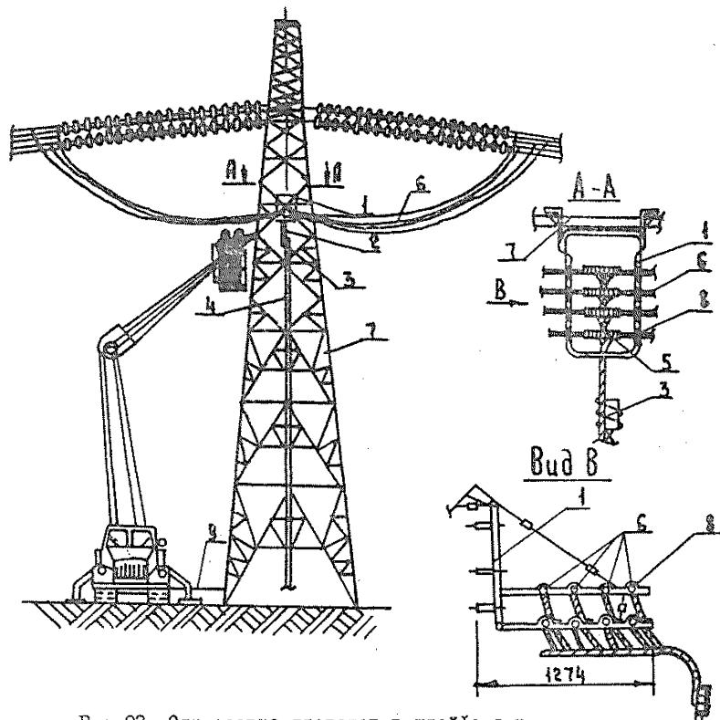
Рис.23. Опрессовка проводов в шлейфе а.у. опоры
