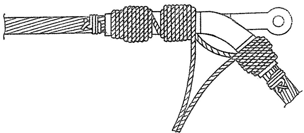
Рис. I4. Установка натяжного зажима с намотанным ДШ
