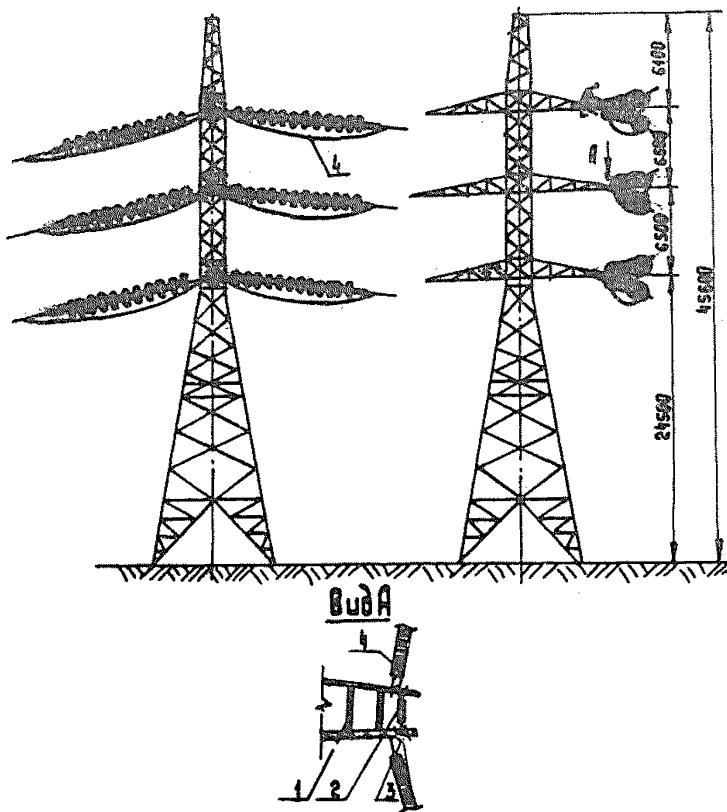
Рис. 24. Одпрессовка проводов в шлейфах анкерно-угловой опоры У-220-2+14:
