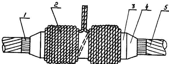
Рис.22. Установка шлейфового зажима с зарядом на провода:
