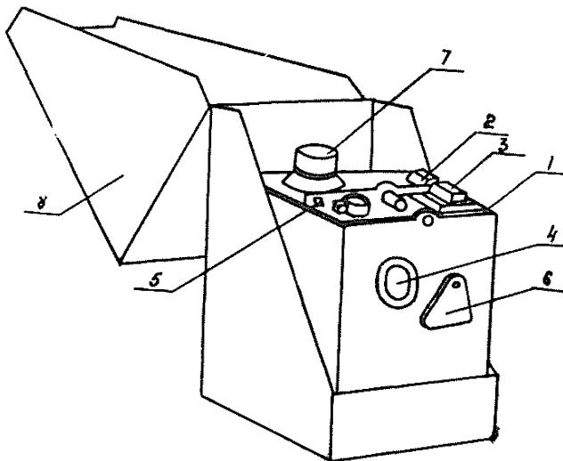
1. Пластмассовый корпус машинки.
