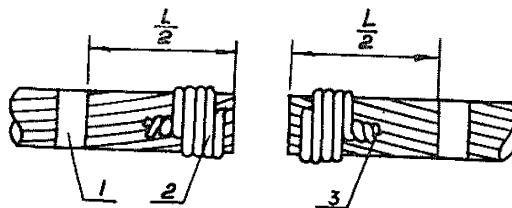
Рис.21. Нанесение меток на проводах:
