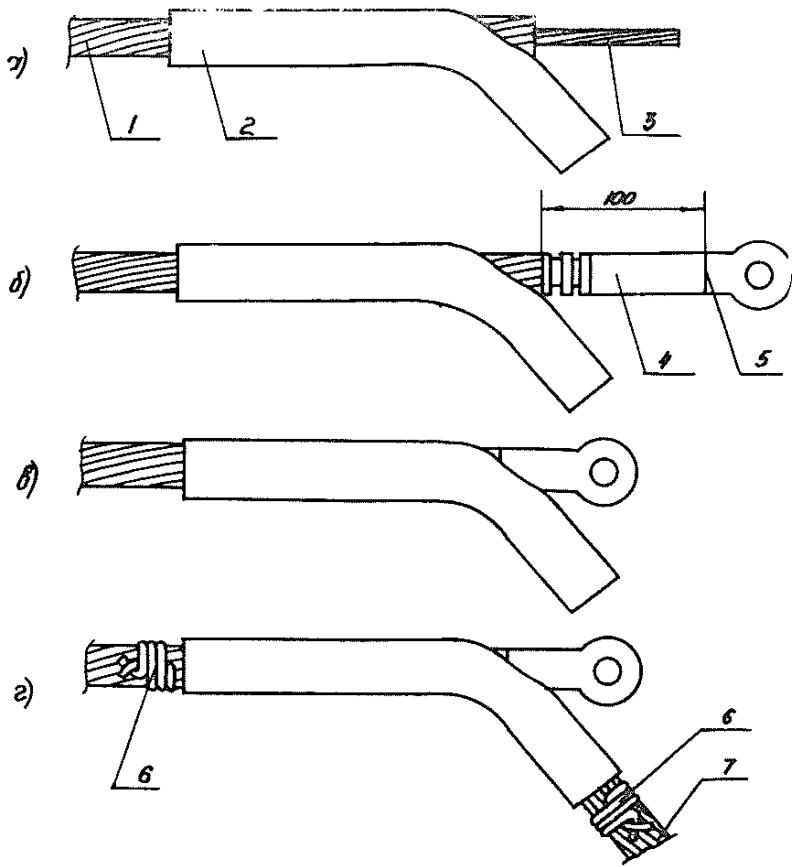
Рис. I3. Монтаж натяжного зажима на проводах:
