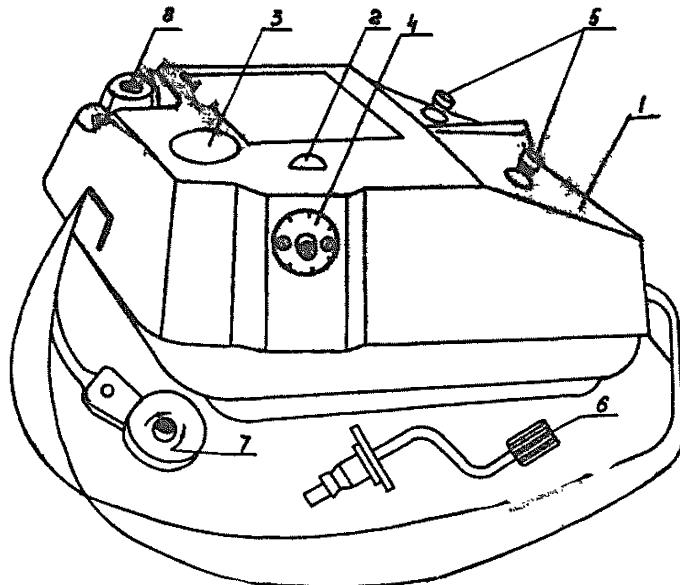
1. Корпус из прочной пластмассы.
