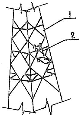
Рис.20. Закрепление приспособления для фиксации проводов на опоре:
