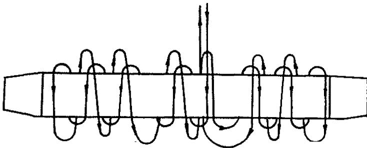
Рис.8. Схема намотки ДШ на корпус соединительного зажима.
