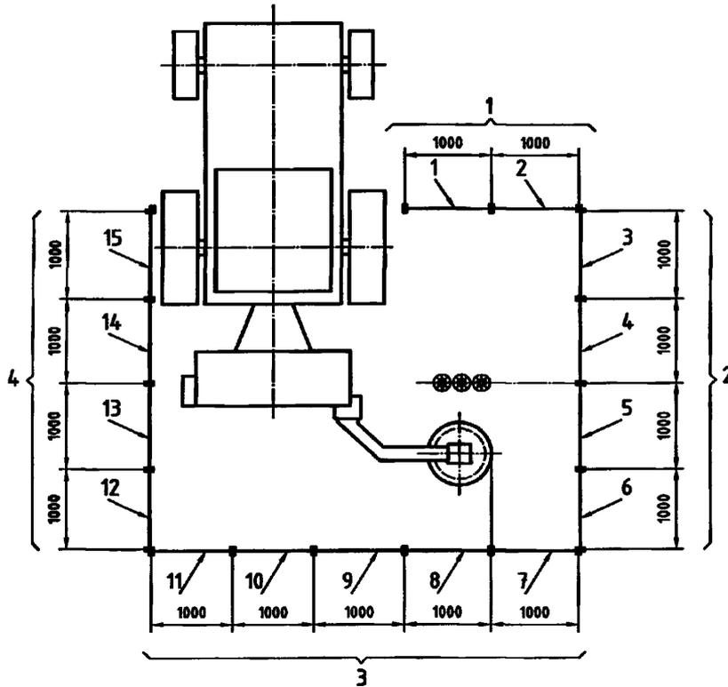
Рисунок 3 – Расположение стенда для испытания на выбрасывание камней
