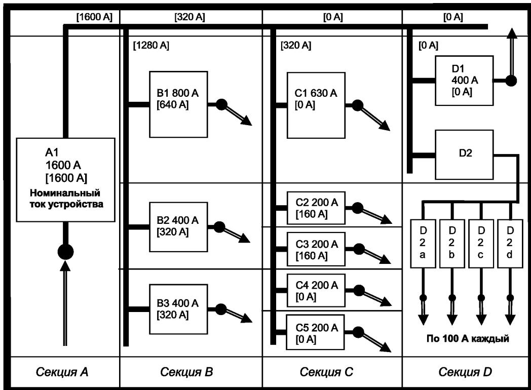
Рисунок Е.2 — Пример 1: Таблица Е.1 — Нагрузка функционального блока для НКУ с номинальным коэффициентом одновременности 0,8
