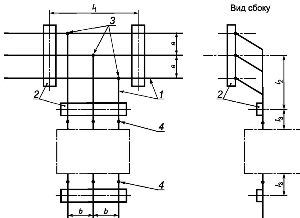
1 — шины; 2 — опоры; 3 — соединения шин; 4 — выводы подсоединения аппаратов;
