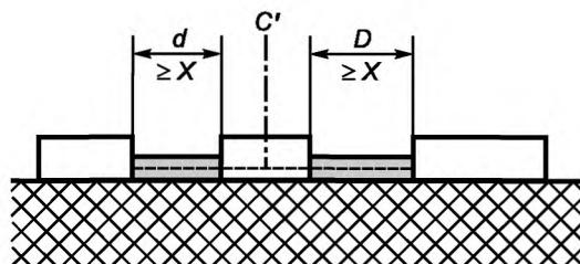
Размер воздушного зазора равен  $d + D$ ; Расстояние утечки равно  $d + D$ ;  $C'$  — свободно движущаяся часть.
