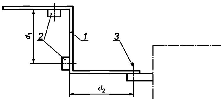
1 — шины; 2 — опоры; 3 — выводы подсоединения аппаратов;
