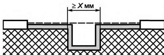
Условие: рассматриваемое расстояние утечки проходит через желобок с параллельными боковыми стенками любой глубины шириной  $X$  мм или более.
