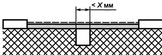
Условие: рассматриваемое расстояние утечки проходит через желобок с параллельными или сходящимися боковыми стенками любой глубины при ширине менее  $X$  мм.
