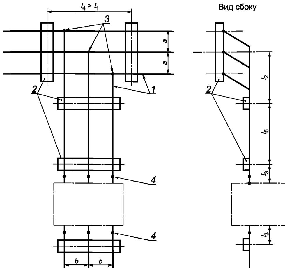
1 — шины; 2 — опоры; 3 — соединения шин; 4 — выводы подсоединения аппаратов;
