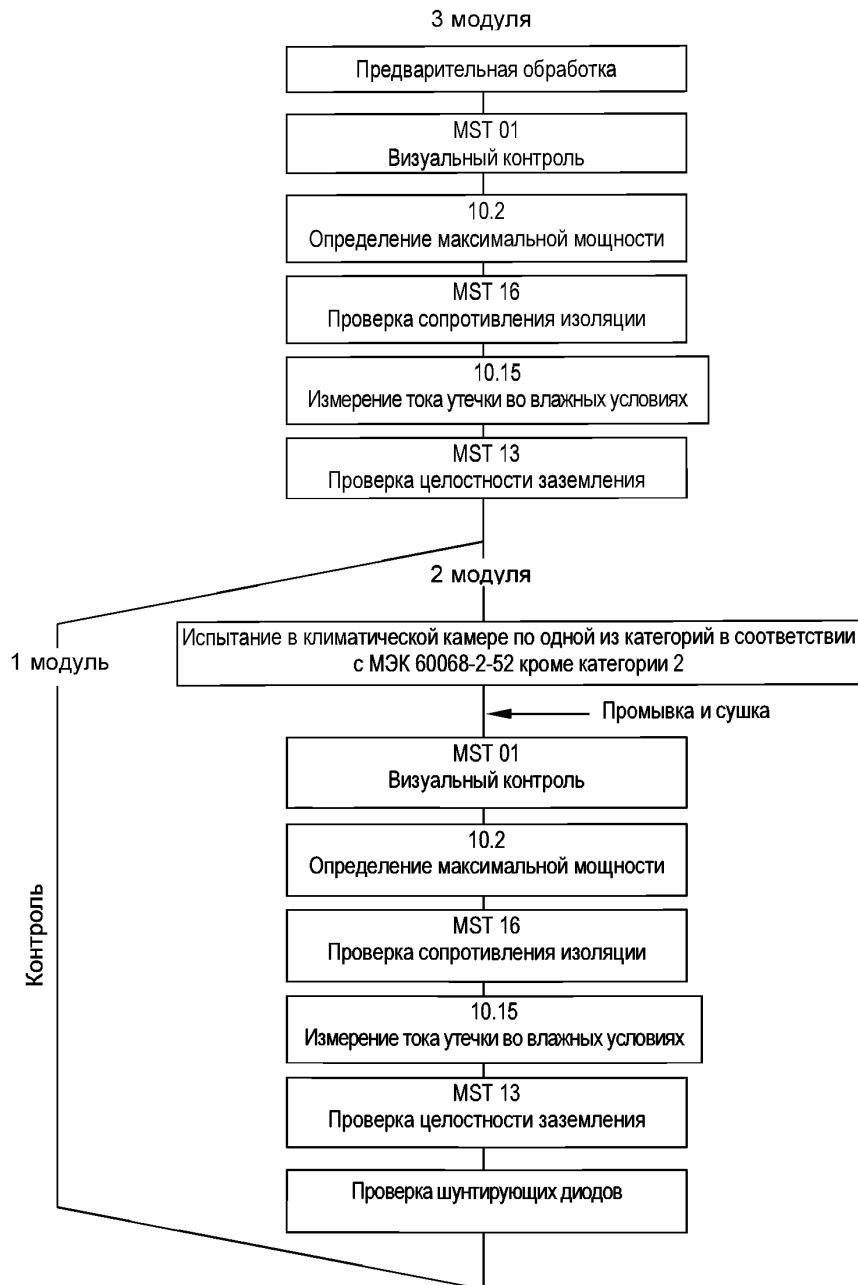
П р и м е ч а н и е 1 – Предварительную обработку результатов измерения по 10.2 и 10.15 проводят в соответствии с МЭК 61215. Измерения MST 13 и MST 16 проводят в соответствии с МЭК 1730-2.
