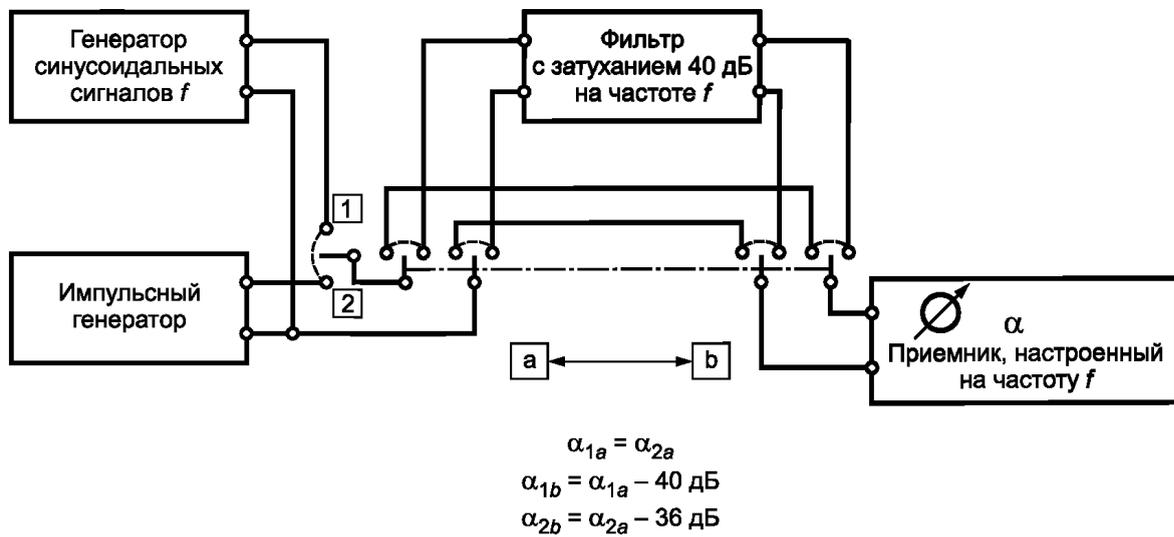
Рисунок 3 – Схема измерения ослабления продуктов интермодуляции
