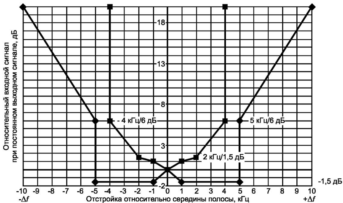
b) Пределы характеристики частотной избирательности ИП для полосы частот В (от 0,15 до 30 МГц)
