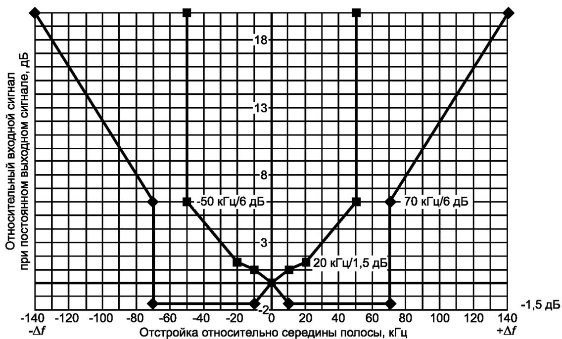
c) Пределы характеристики частотной избирательности ИП для полос частот С и D (от 30 до 1000 МГц)
