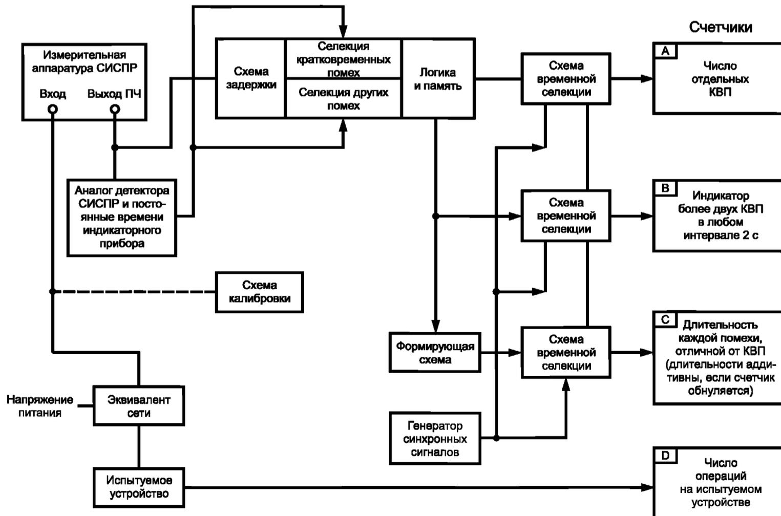
Рисунок 6 — Пример блок-схемы анализатора кратковременных ИРП
