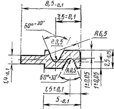
Примечание. Профиль ключа может быть изготовлен в зеркальном исполнении относительно указанного профиля.
