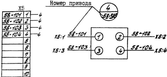
1-й вариант: номер привода входит непосредственно в маркировку и на изделии проставлен на конце провода
