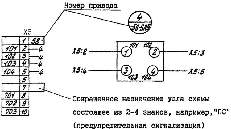
2-й вариант: номер привода в маркировку не входит и на изделии проставлен на флажке, закрепленном на зажиме I блока зажимов Х5. В маркировку на конце провода номер привода не входит
