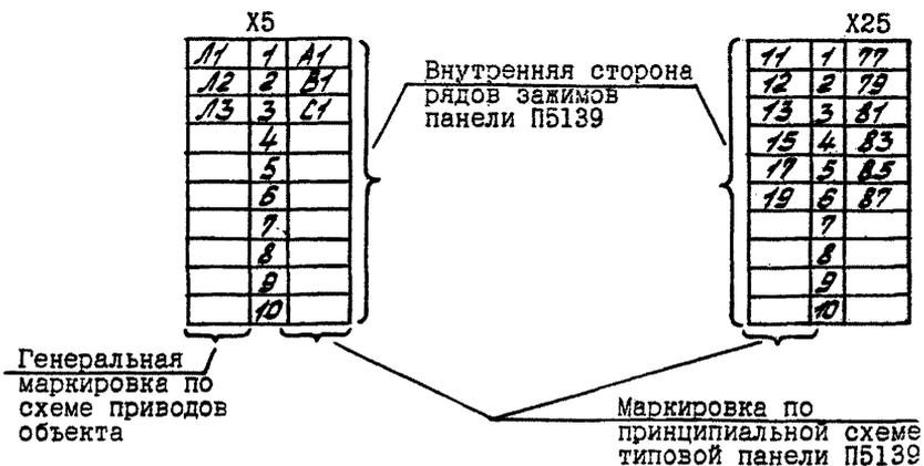
2-й вариант: типовая панель имеет маркировку цепей по принципиальной схеме панели
