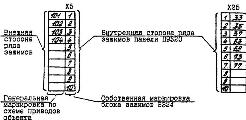
1-й вариант: типовая панель не имеет внутрипанельной маркировки цепей по принципиальной схеме панели
