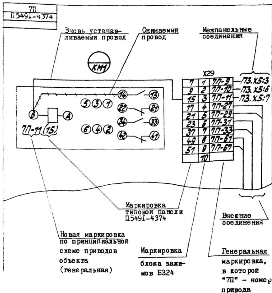
Для типовых ненормализованных блоков, панелей, шкафов и ящиков при перекоммутации менее 10 проводов к комплекту передаваемых документов должны прилагаться измененные узлы принципиальной схемы, при перекоммутации более 10 проводов - новая принципиальная схема.
