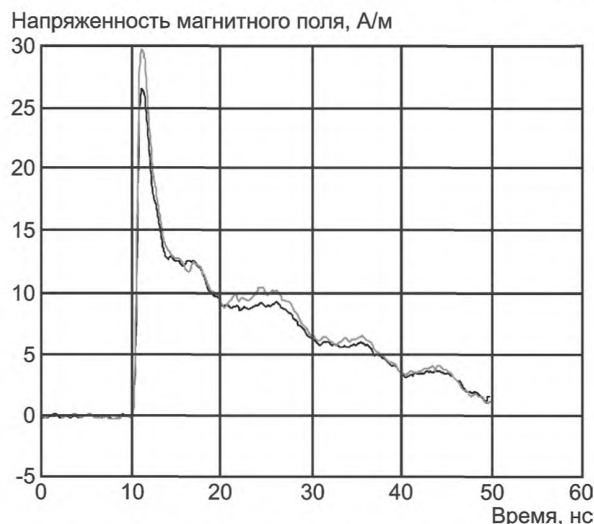
Рисунок D.2 – Зависимость от времени напряженности магнитного поля при электростатическом разряде от человека, держащего металлический предмет, заряженный до напряжения 5 кВ. Измерения на расстоянии 0,1 м при длине дуги 0,5 мм и времени нарастания силы тока 500 пс
