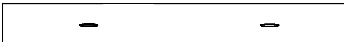
Пример 2 — две несплошности длиной по 6,4 мм
