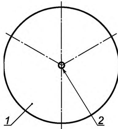
1 – датчик из электротехнической меди диаметром 40 мм; 2 – расположение термопары с центральным отверстием диаметра 1,2 мм и глубины 1,3 мм
