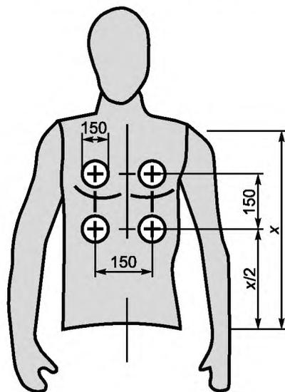
Рисунок 7 – Манекен с четырьмя датчиками, вид спереди
