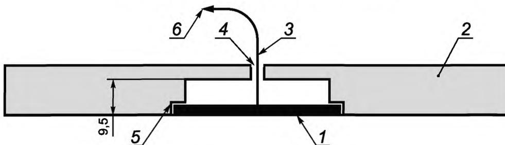
1 – диск из электротехнической меди массой 18 г, диаметром 40 мм, толщиной 1,6 мм (закрепленный на месте штифтами); 2 – изоляционный картон минимальной толщиной около 1,3 см; 3 – Термопара типа К (NiCr-NiAl) или типа J (Fe-CuNi); 4 – отверстие диаметром 3,2 мм; 5 – выступ 1,6x1,6 мм; 6 – сигнал для сбора данных
