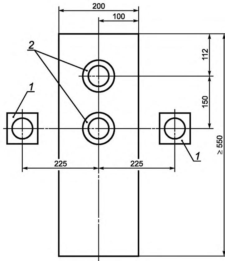
1 – контрольные датчики; 2 – датчики, вмонтированные в панель
