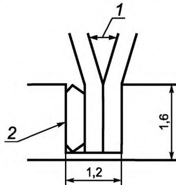
1-отдельные термоэлектроды; 2-расположение термопары общим наружным диаметром 0,254 мм: в отверстие вдавливается пробка до полного заполнения. Точка разделения термоэлектродов находится на поверхности медного диска
